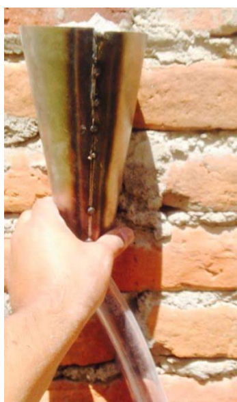
Figura 25. Experimento 2 – Acumulación de arena para verificación de su fluidez.
