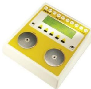
Figura 41. Analizador desfibrilador QA-40M.
