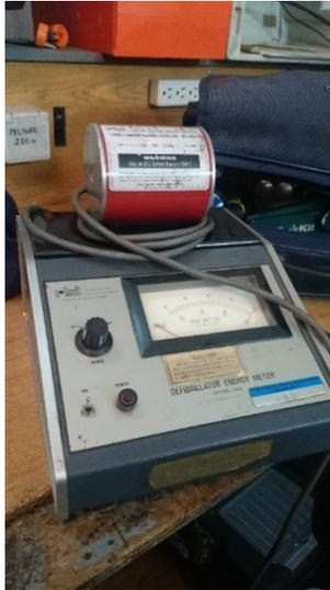
Figura 44. Equipo Desfibrillador energy tester.
