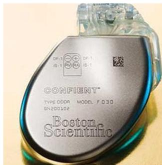
Figura 22. Desfibrilador automático implantable.
