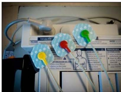
Figura 14. Desfibrilador con monitor ECG.
