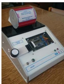
Figura 79. Implementación del medidor desfibrilador.
