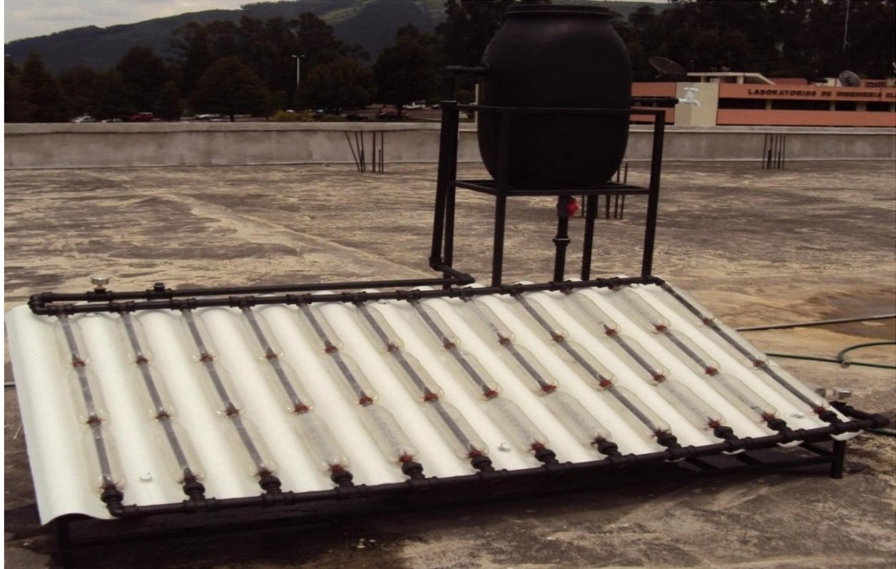
Prototipo del colector solar de botellas PET
