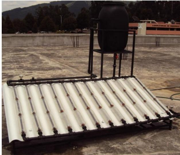
**Figura 27 Prototipo del nuevo colector solar de botellas de PET**
