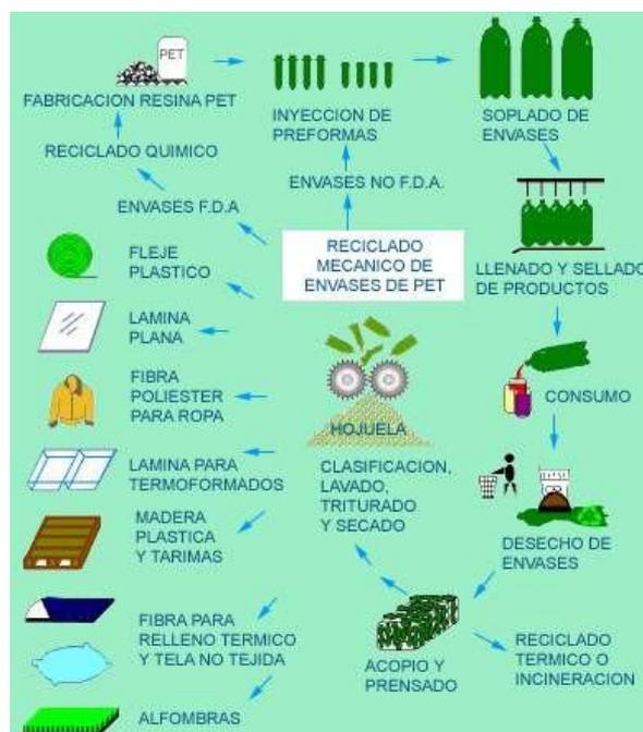
**Figura 25** Proceso de reciclado mecánico
