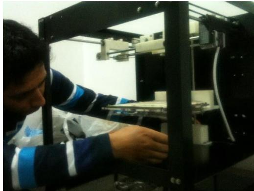
Figura 108. Sujeción del sistema de elevación de la cama caliente, en la carcasa de la impresora 3D.
