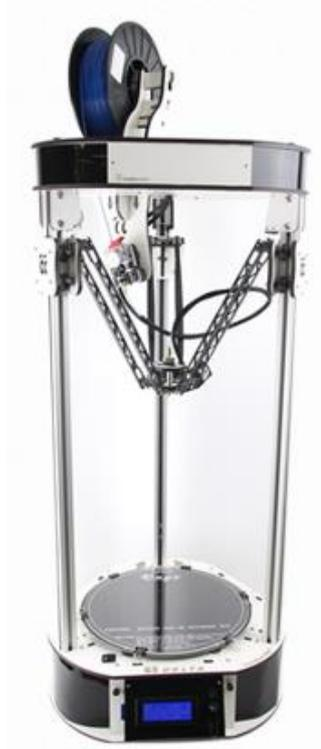
Figura 33. Impresora 3D tipo delta, Rostock Max.
