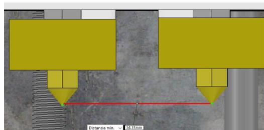
Figura 130. Distancia entre boquillas de los extrusores MK8.
