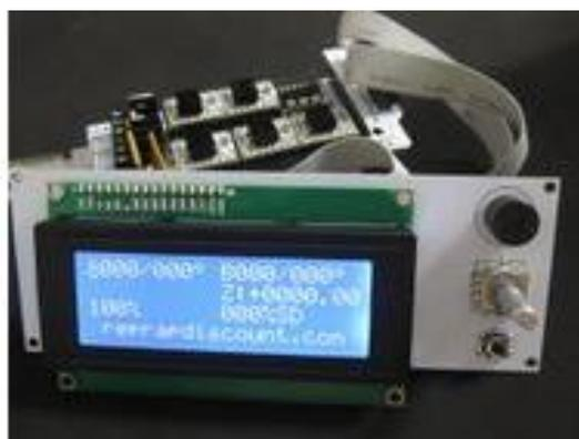
Figura 63. LCD REPRAP Discount Smart Controller conectado en un módulo RAMPS.
