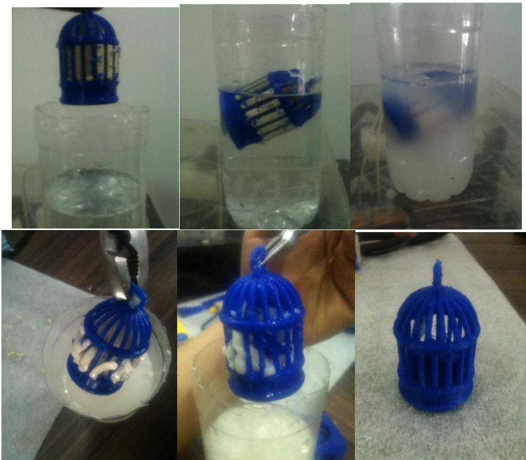
Figura 138. Proceso de remoción de material de soporte (PVA).
