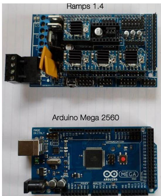
Figura 46. Tarjeta Arduino Mega y Tarjeta RAMPS.
