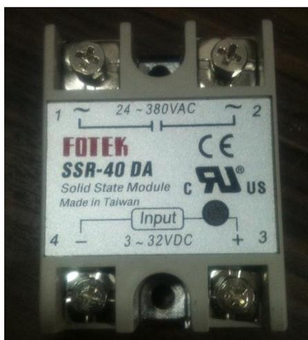
Figura 73. Relé de estado sólido FOTEK SSR-40 DA.
