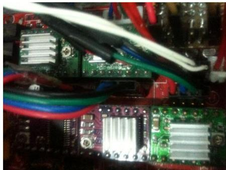
Figura 62. Placa RAMPS, con los módulos A4988 y A8825.
