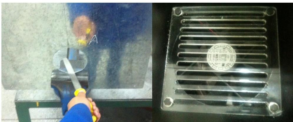
Figura 113. Conducto de aire ventilador, entre la caja térmica y la cámara principal de la impresora.
