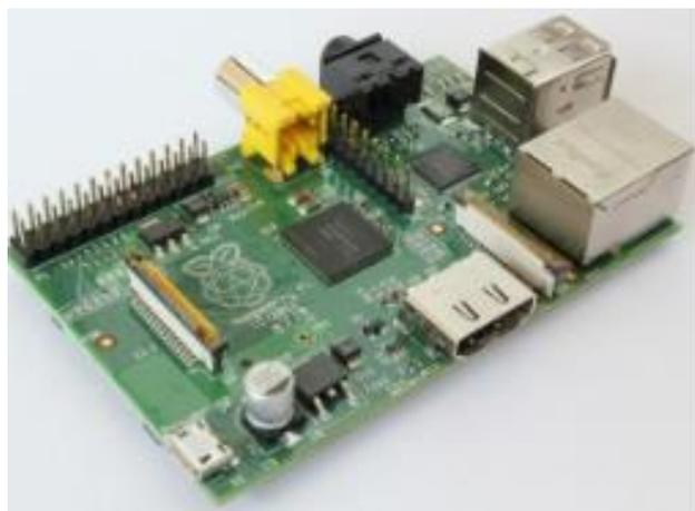
Figura 45. Tarjeta Raspberry Pi.
