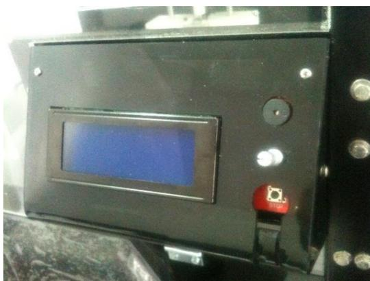
Figura 120. Placa LCD REPRAP Discount Smart Controller, fijada en la carcasa de la máquina
