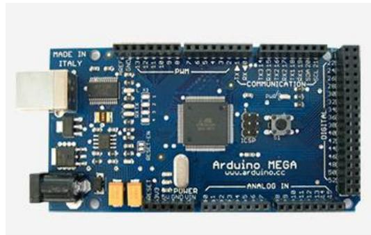
Figura 58. Placa Arduino Mega.
