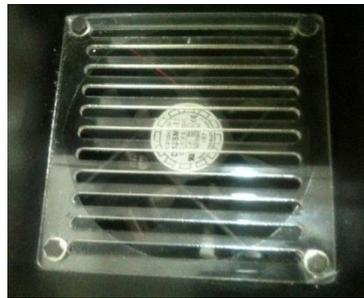
Figura 71. Ventilador para el flujo de aire caliente.
