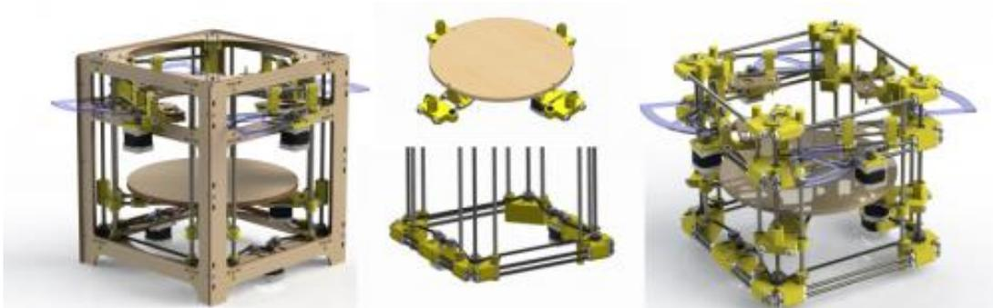
Figura 19. Impresora 3D con 4 extrusores estructura polar Theta.
