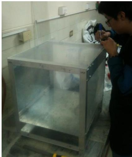
Figura 100. Montaje de la carcasa previo a ser pintado.
