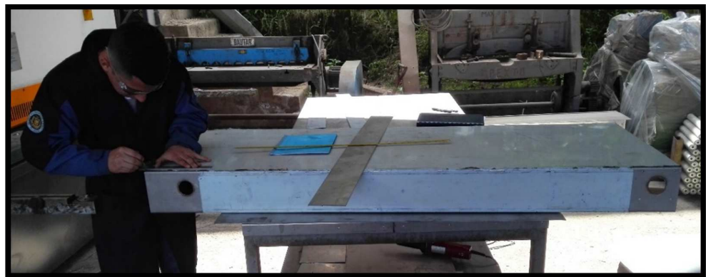
Figura 157 Trazado de medidas bastidor de la banda transportadora
