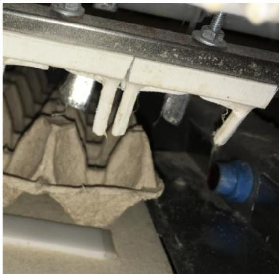
Figura 76 Detección de cubeta por el sensor óptico
