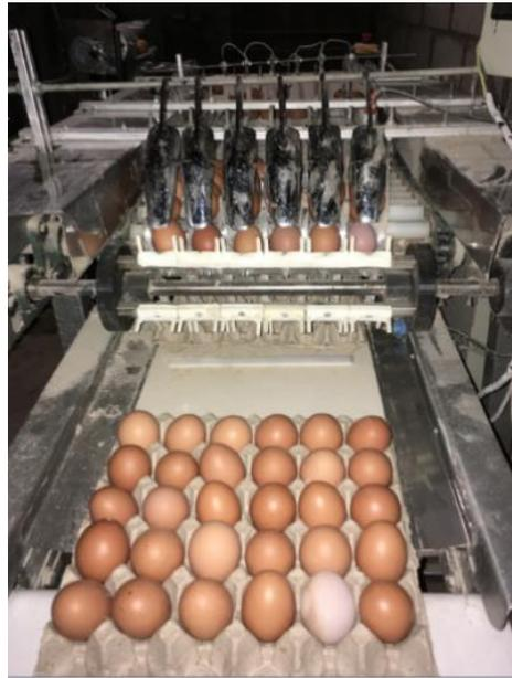
Figura 81 Cubeta con huevos siendo tomada por la banda de salida
