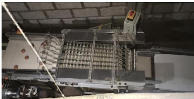
Figura 68 Sistema empacador ensamblado vista superior
