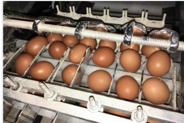
Figura 77 Huevos en la banda de rodillos alineados por las guías
