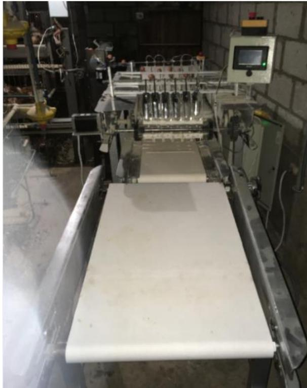
Figura 69 Sistema empacador ensamblado vista lateral
