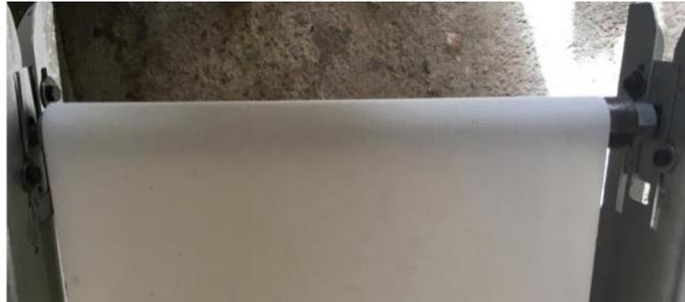
Figura 70 Banda deslizando hacia un lado
