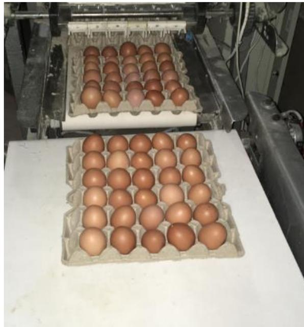
Figura 83 Sistema empacando a 5 filas por hilera
