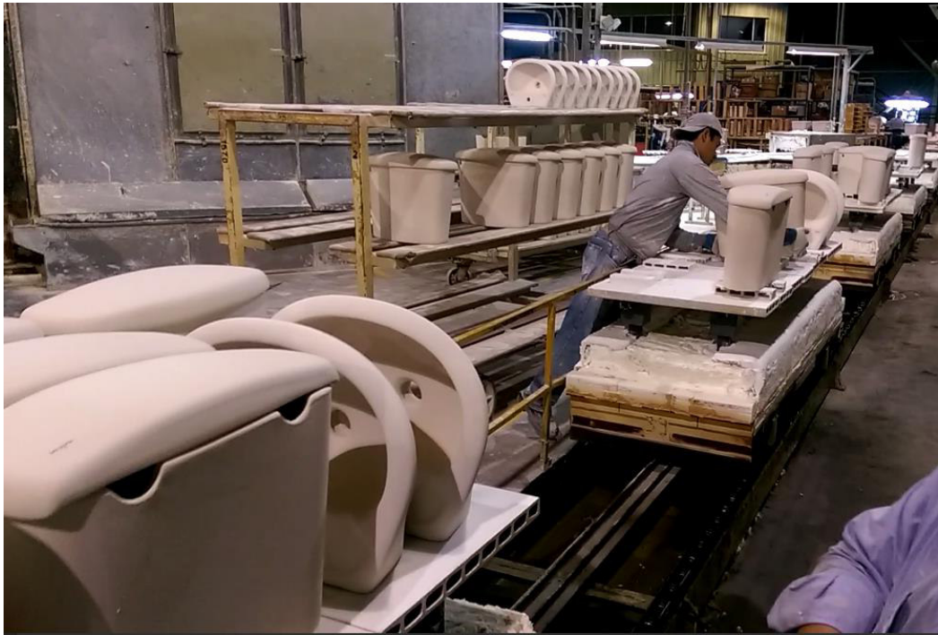
Figura 63 Operador cargando correctamente las piezas
