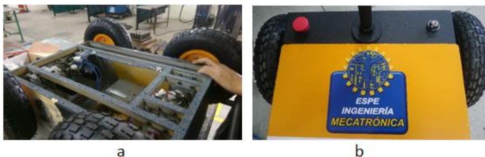
Figura 88: (a) cableado de los motores en la plataforma y (b) botón de paro de emergencia e interruptor de encendido con llave instalados en la plataforma.
