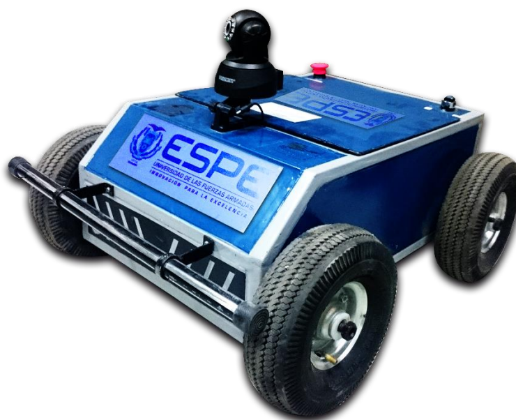
Figura 8: Plataforma robótica para exteriores del Laboratorio de Manufactura.
