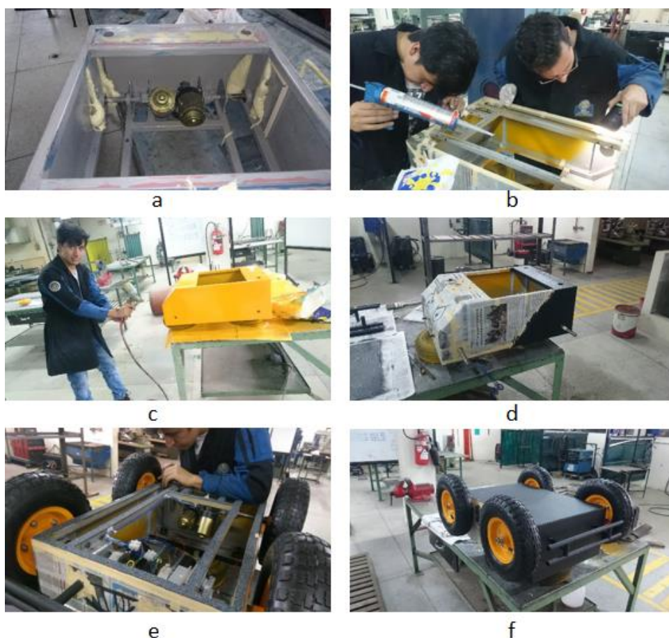
Figura 85: Inclusión de material sellante en las juntas de la estructura y pintado de la plataforma; (a) llenado de espacios con Sika-boom, (b) sellado con Sika Bond AT-Metal, (c) recubrimiento pintura anticorrosiva, (d) recubrimiento pintura batapedra, (e) pegado del empaque parte inferior (f) cerrado de la parte inferior.
