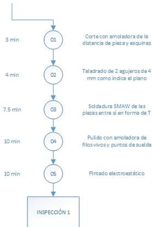
Figura 130 Diagrama de procesos: Pivote de piernas
