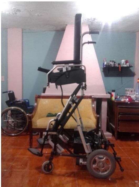
Figura 149 Prueba de bipedestación sin carga
