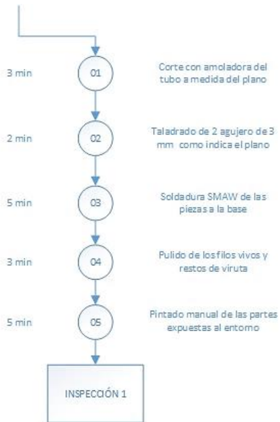
Figura 135 Diagrama de procesos: Soporte de asiento
