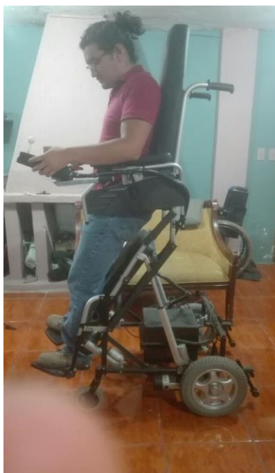
Figura 150 Prueba de bipedestación con carga
