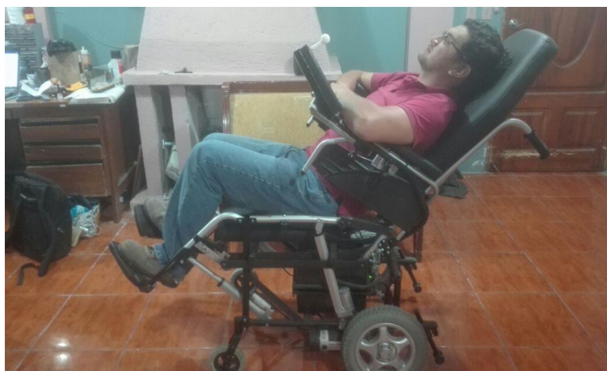
Figura 148 Prueba de inclinación con carga
