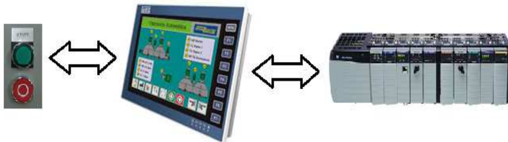
Figura 59. Alternativa. Accionador – pantalla HMI - PLC.
