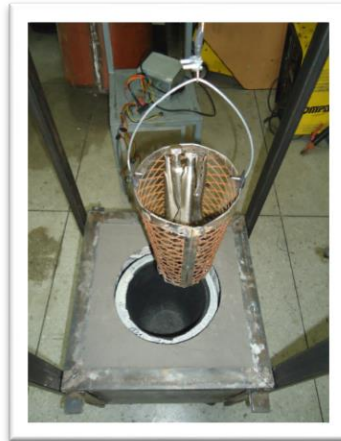
Figura 46 Recipiente para la inmersión de las piezas a galvanizar.
