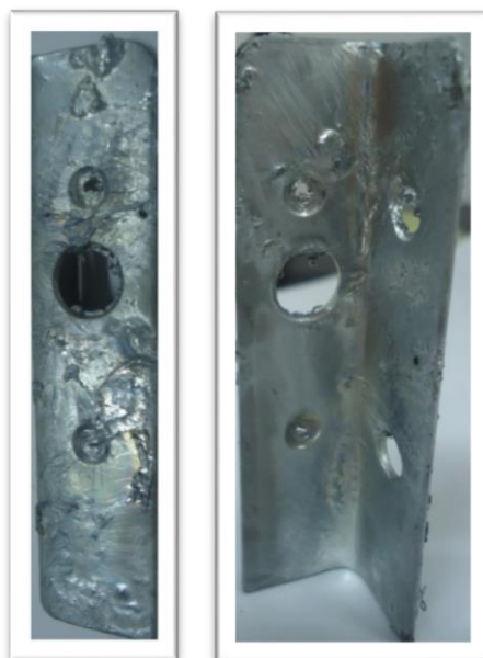
Figura 51 Pieza con residuos al momento de sacarla de la colada.
