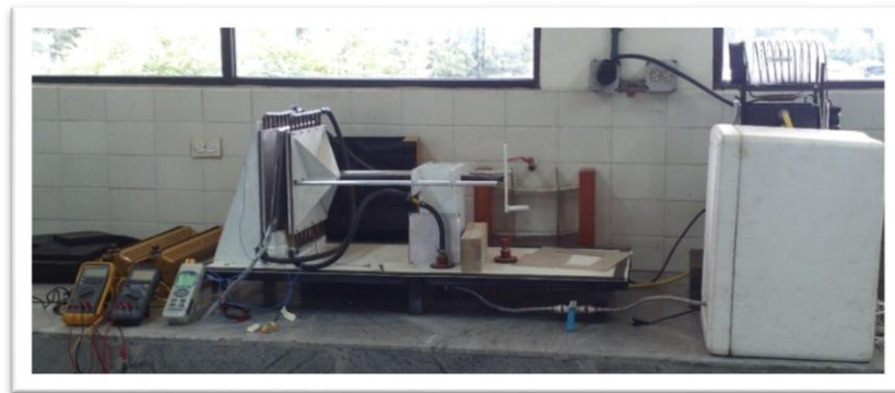
Figura 36 Máquina de medición de conductividad Térmica
