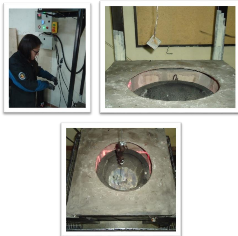
Figura 10 Proceso de galvanizado por inmersión en caliente
