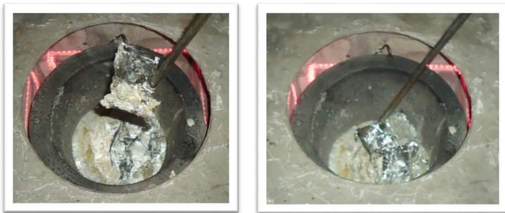
Figura 53 Limpieza de residuos en la colada de zinc.
