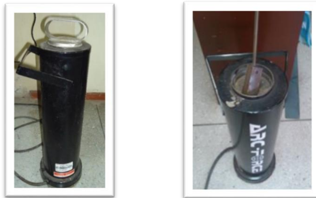
Figura 9 Secado de pieza a 80 °C
