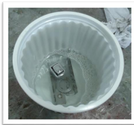
Figura 6 Limpieza de la pieza en Ácido clorhídrico
