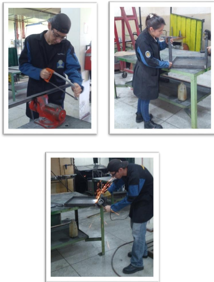
Figura 39 Medición, corte y soldadura de la base del horno
