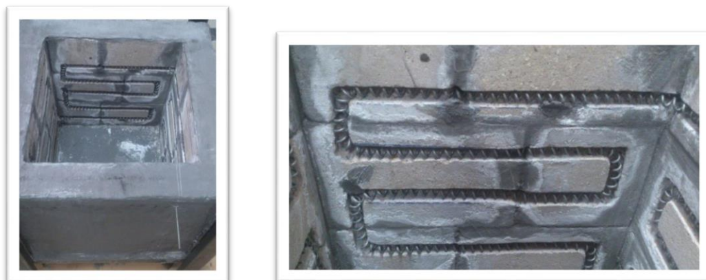
Figura 41 Montaje de Niquelina en las paredes del horno
