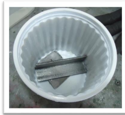
Figura 7 Limpieza el de pieza previa al baño de sales
