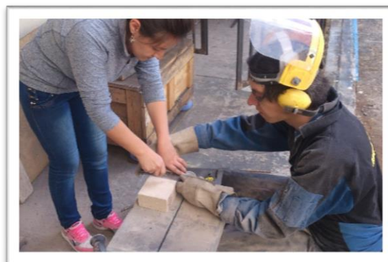
Figura 37 Corte y medición de ladrillos refractarios
