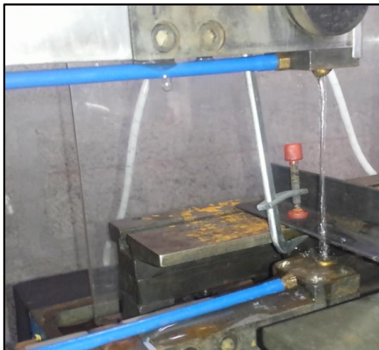
Figura 58 Sistema de aspersion o flushing de fluido dieléctrico.
