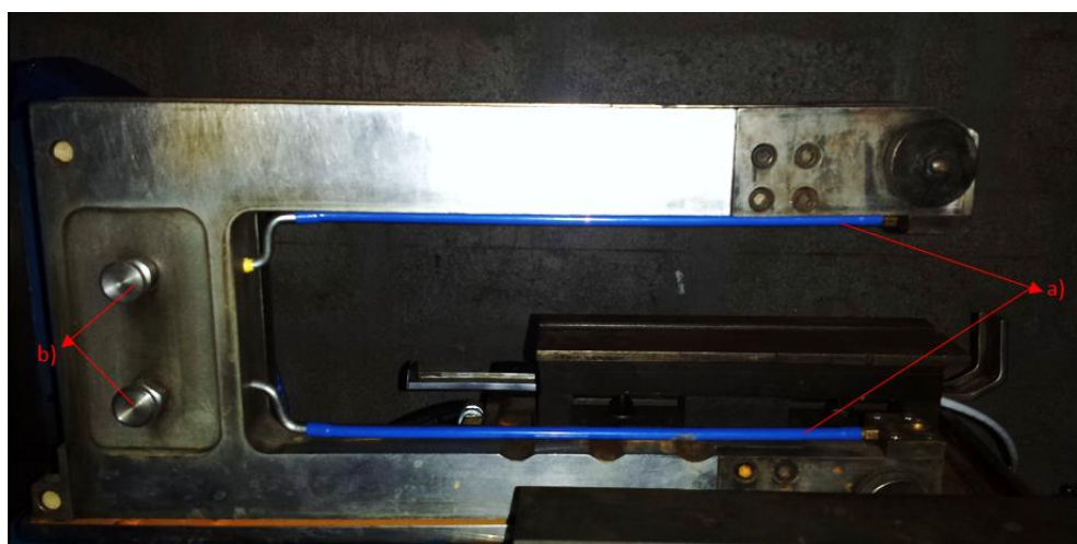
Figura 57 Espacio de trabajo. a) Mangueras de 6mm. b) Reguladores de caudal.
