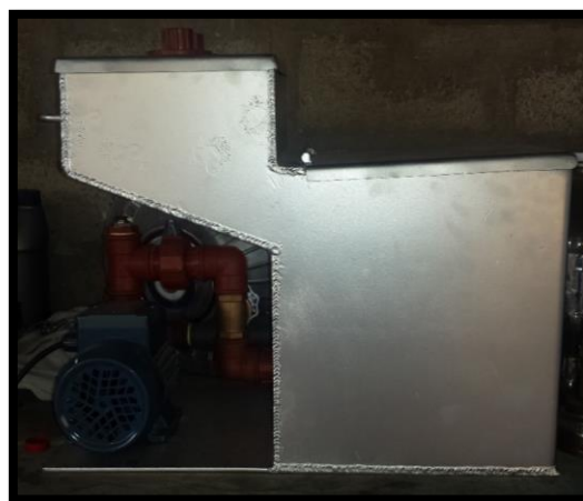
Figura 56 Sistema construido de circulación y filtrado de fluido dieléctrico.
