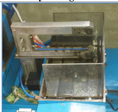
Figura 136 Prueba de mangueras endurecidas y reguladores de caudal.
