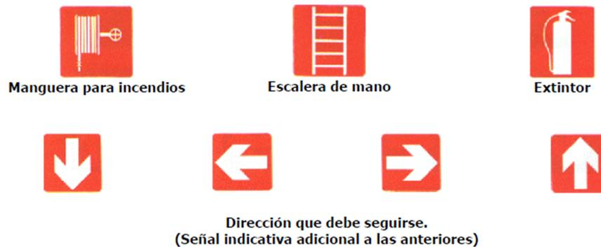
**Figura 6. Señales informativas para equipos de seguridad**
