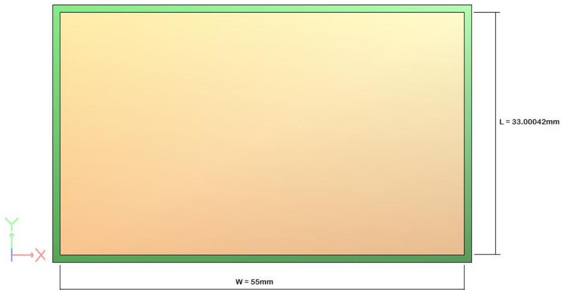
Figura 4.9. Configuración del Parche Individual con el Ancho extendido a 55mm.
