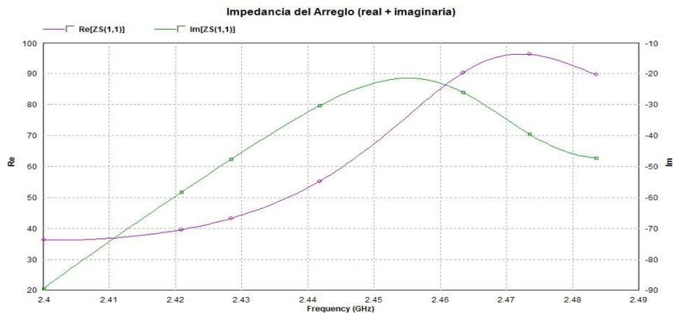
Figura 5.22. Impedancia vs Frecuencia del arreglo del Diseño #4 sin optimizar (Real+Imaginaria)
