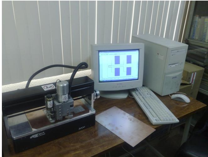
Figura 6.8: Sujeción y puesta a punto de la placa sobre la prototipadora
