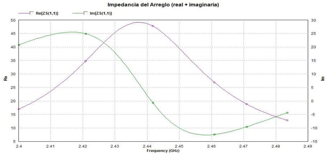
Figura 5.28. Impedancia vs Frecuencia del arreglo del Diseño #2 optimizado (Real+Imaginaria)
