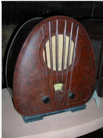
Figura 3.5. Radio construido con partes de baquelita
