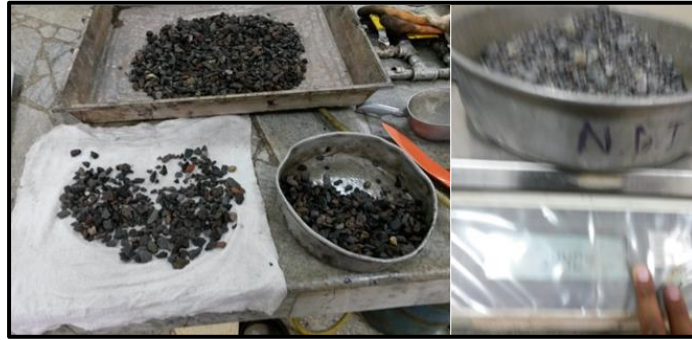
Figura 43. Eliminación del exceso de agua superficial en el agregado
