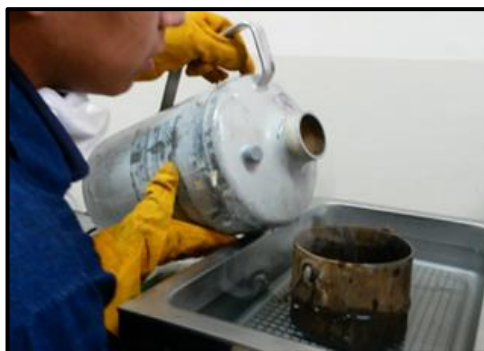
Figura 92. Vertido de nitrógeno líquido sobre la muestra.
