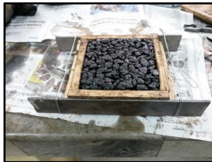
Figura 99. Muestra rectangular con sujetadores, en periodo de enfriamiento, después de la compactación.
