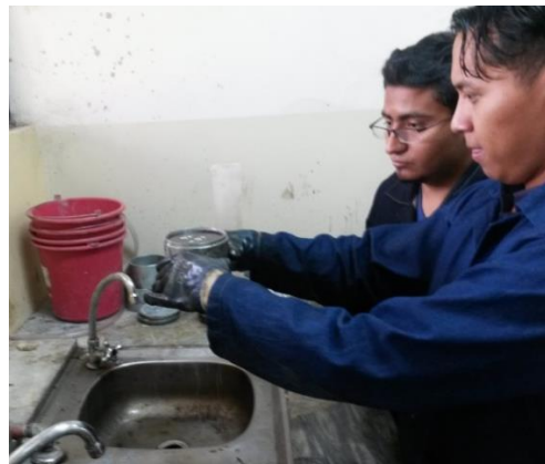
Figura 79. Filtración de agua en mezcla drenante.
