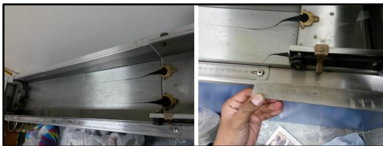
Figura 61. Izq. Finalización del ensayo de ductilidad; Der.- Medición en centímetros de la ductilidad del asfalto.
