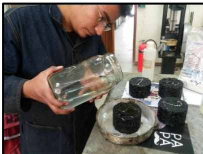
Figura 95. Vertido del compuesto en la briqueta drenante.
