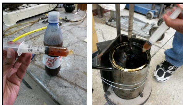
Figura 51. Izq.- Jeringa con aditivo; Der.- Colocación de aditivo en el asfalto virgen.
