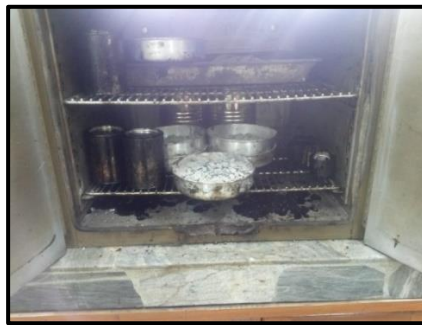
Figura 67. Muestra de agregados y asfalto en el horno.
