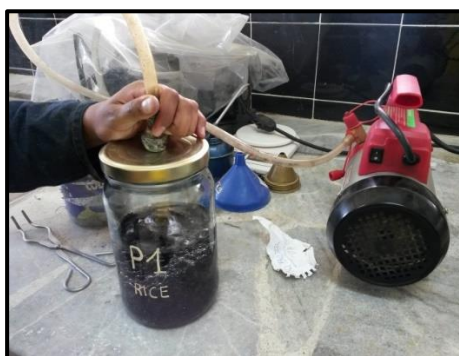
Figura 76. Picnómetro con muestra en la máquina de vacíos.
