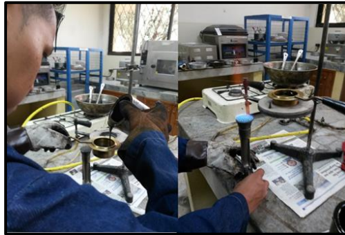
Figura 3. 1 Izq.- Vertido del asfalto en la copa Cleveland; Der.- Instalación de mechero y soporte.
