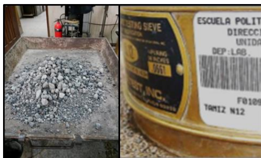
Figura 42. Separación del agregado a través del tamiz No.12
