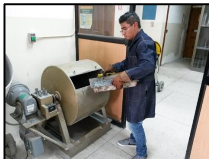
Figura 41. Colocación del Agregado en la Máquina de los Ángeles
