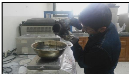
Figura 68. Vertido del asfalto en los agregados.
