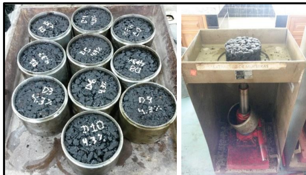
Figura 73. a) Briquetas de mezcla drenante en proceso de enfriamiento; b) Briqueta extraída del molde.
