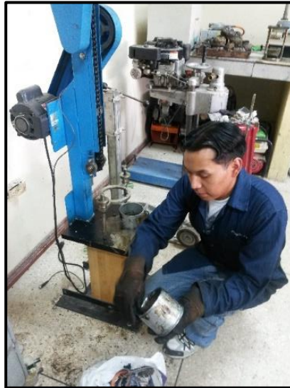
Figura 72. Inversión de la briqueta para compactación por ambas caras.
