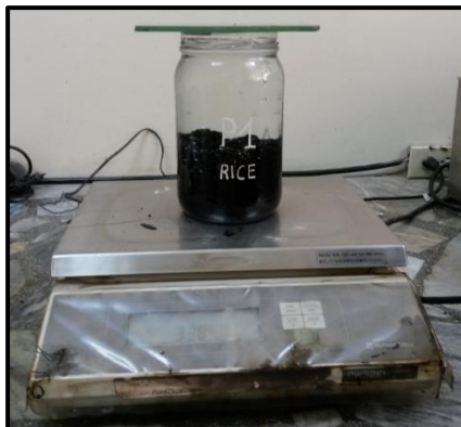
Figura 77. Toma del peso del picnómetro + muestra + agua.
