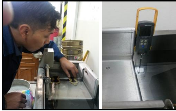
Figura 59. Izq.- Muestras colocadas en máquina para ductilidad; Der.- Control de la temperatura de ensayo.
