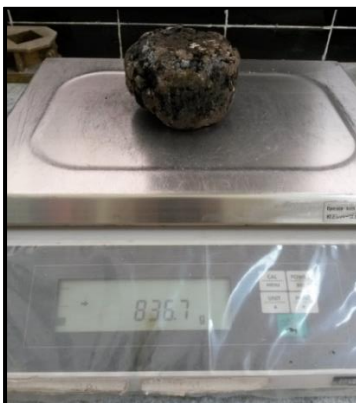
Figura 84. Registro del peso una briqueta después del Ensayo Húmedo.
