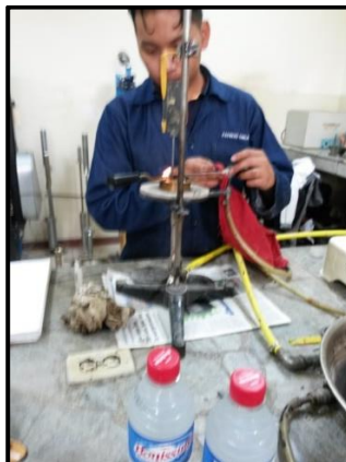
Figura 62. Paso de mechero por la superficie del asfalto.
