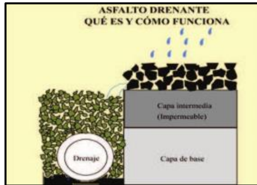
Figura 24. Estructura y funcionamiento de los asfaltos drenantes.
