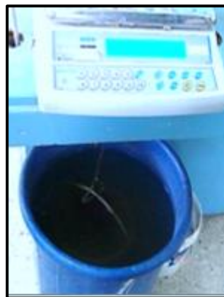
Figura 44. Muestra de agregado grueso sumergido en el tanque de inmersión
