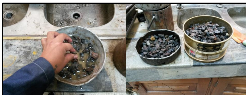
Figura 48. Izq.- desintegración de partículas manualmente; Der.- tamizado de la muestra.
