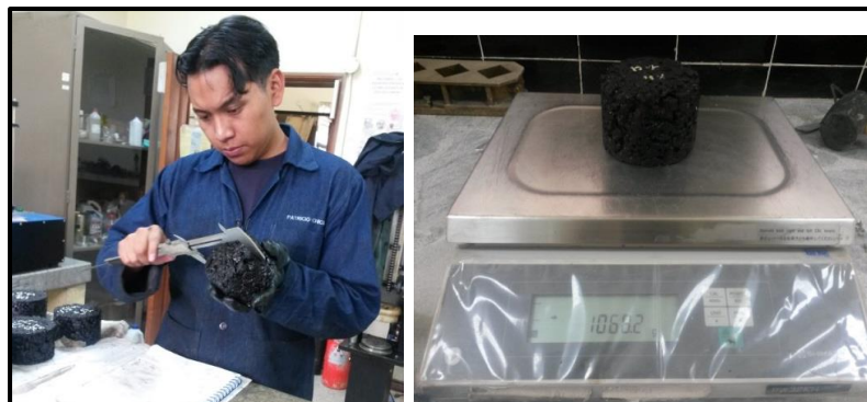
Figura 74. Toma de medidas y peso a briquetas de mezcla drenante.
