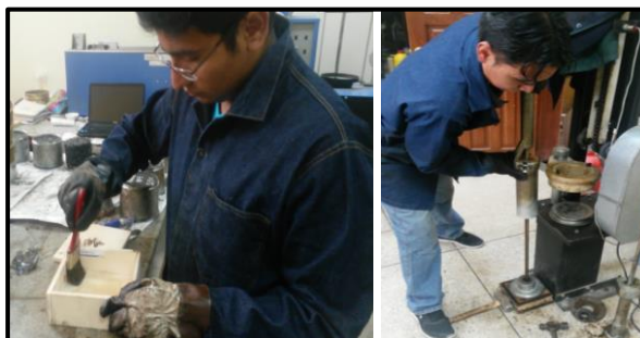
Figura 98. Engrasado de molde de madera y compactación de muestra.
