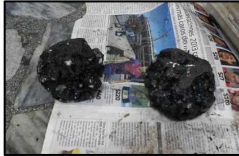
Figura 118. Briquetas con aceite de vaselina después de ensayo cántabro.
