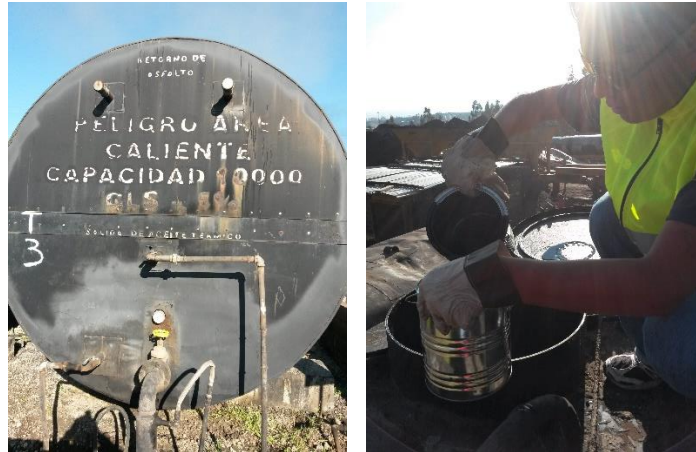
Figura 23. Izq.- Tanque de almacenamiento de asfalto; Der.- Muestreo in situ de material asfáltico.
