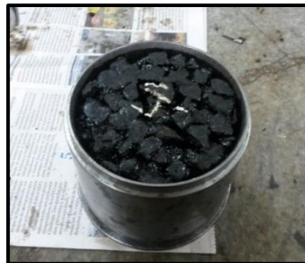
Figura 102. Briqueta de mezcla drenante en molde Marshall para ensayo de envejecimiento.
