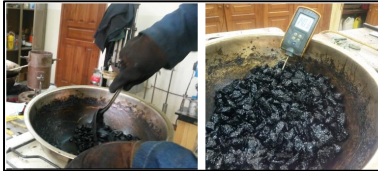
Figura 69. Izq.- Mezclado de material; Der.- Control de temperatura de mezclado.
