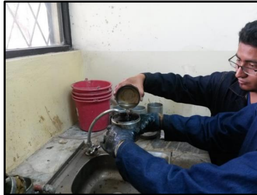
Figura 78. Vertido de 100 ml de agua sobre una briqueta de mezcla drenante.
