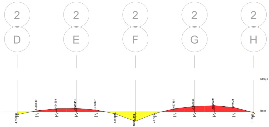
Figura 76. Diagrama de momentos Eje 2 sentido X (Etabs2015)
