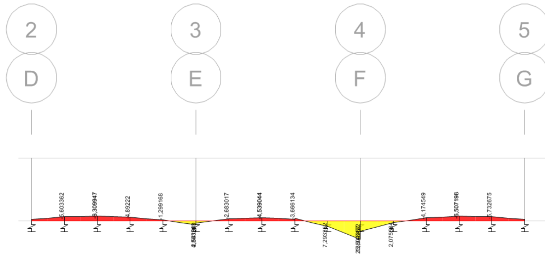
Figura 77. Diagrama de momentos Eje J sentido Diagonal (Etabs2015)
