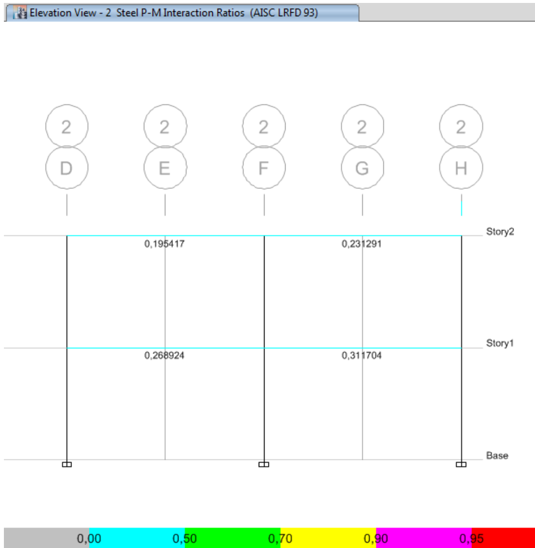
Figura 65. Bloque2 pórtico vigas sentido X (Etabs2015)
