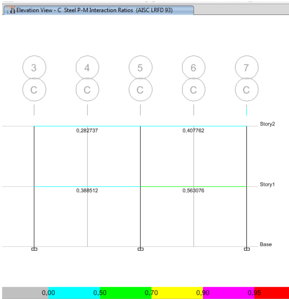
Figura 67. Bloque2 pórtico vigas sentido Y (Etabs2015)
