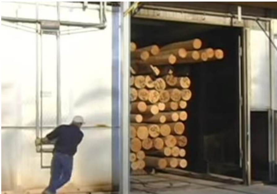
Figura 10: Horno de secado de la madera (Fuente: COX Industries y United Wood Treatment Co.)
