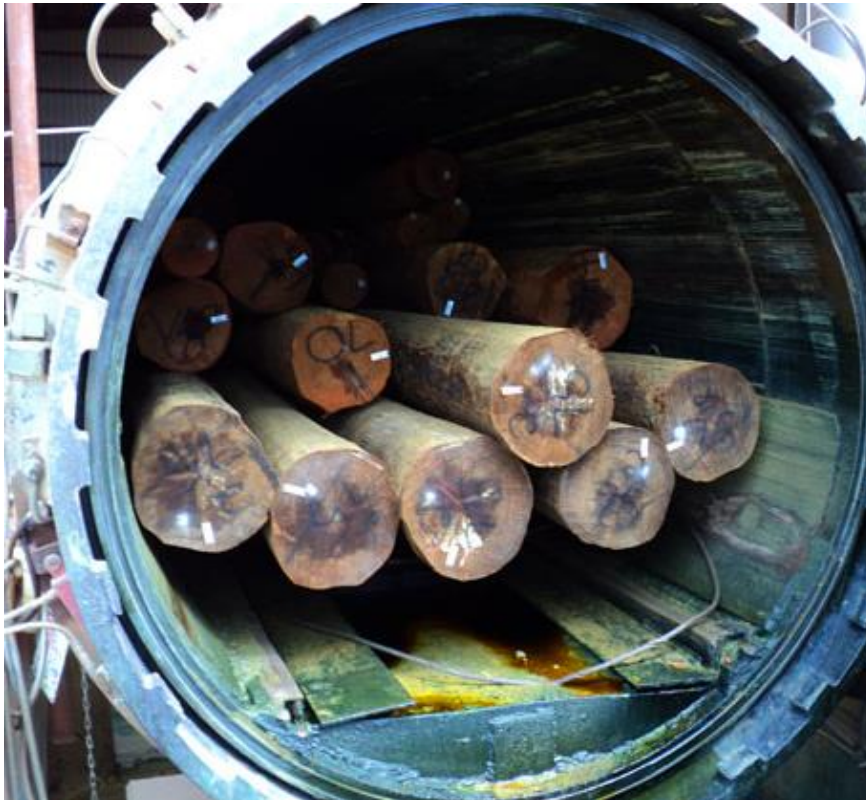
Figura 12: Hornos de presión para tratamiento de madera. (Fuente: COX Industries y United Wood Treatment Co.)
