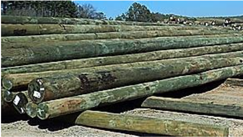
Figura 13: Diferencia visible de la madera tratada a presión.
