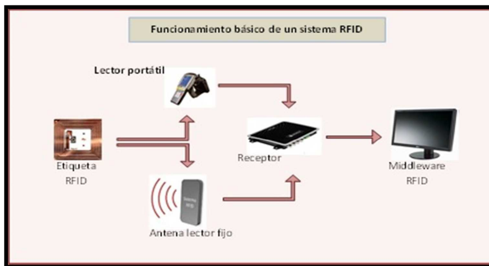
Figura 2. Funcionamiento Sistema RFID
