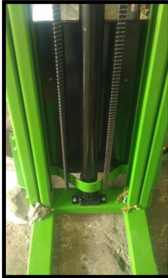
**Figura 91** Montaje del cilindro hidráulico en la estructura principal.
