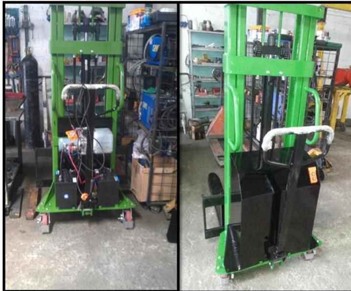
**Figura 97** Montaje de la tapa de protección en la estructura
