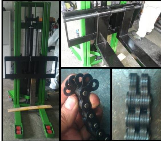
**Figura 94** Montaje de porta horquillas y cadenas
