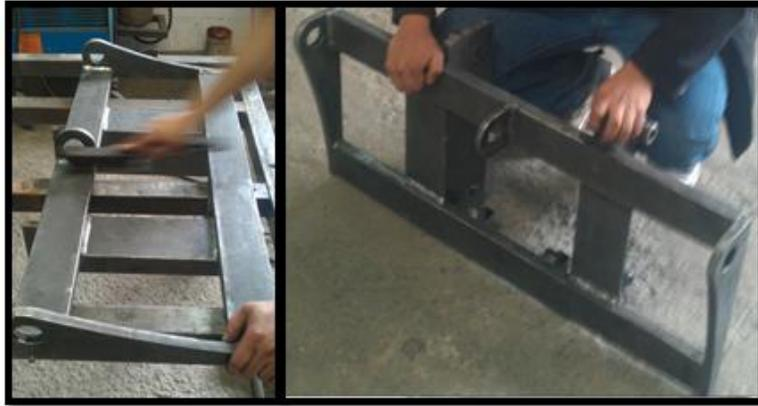
**Figura 77** Construcción de porta horquillas
