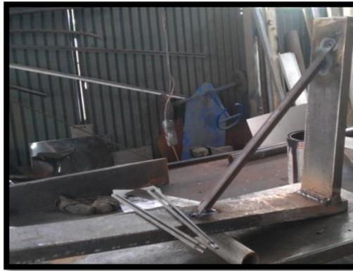
**Figura 75** Soldadura del perfil estructural tipo C de las horquillas
