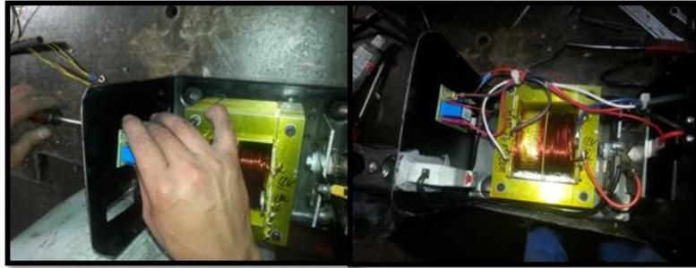
**Figura 86** Montaje del circuito de control de carga.
