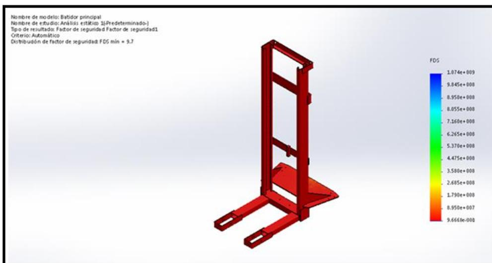
**Figura 42** Factor de seguridad de las vigas inferiores
