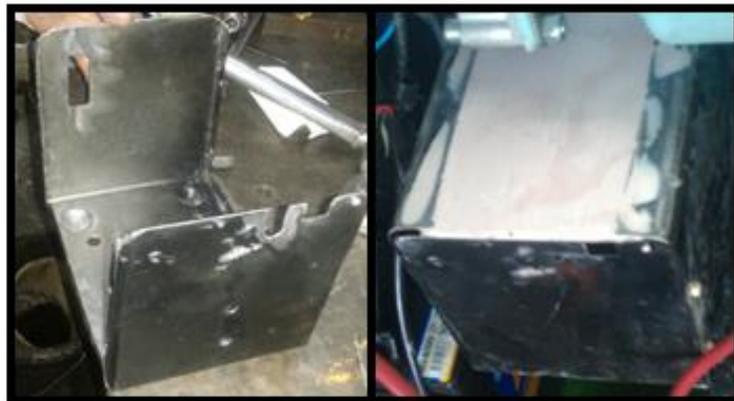
**Figura 83** Fabricación de la caja del cargador de baterías.
