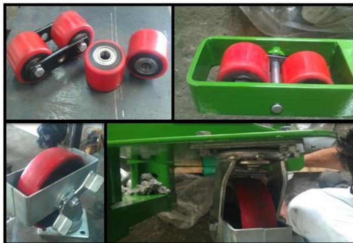
**Figura 93** Montaje de las ruedas en la estructura.
