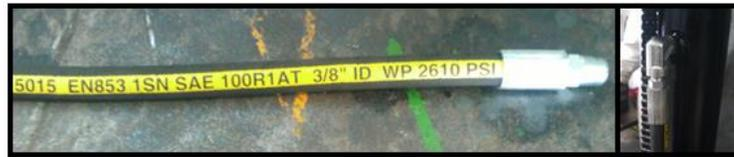
**Figura 65** Mangueras y acoples hidráulicos seleccionados.
