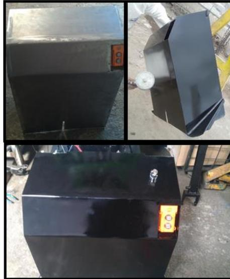
**Figura 96** Fabricación de la tapa de protección para los sistemas eléctrico e hidráulico.
