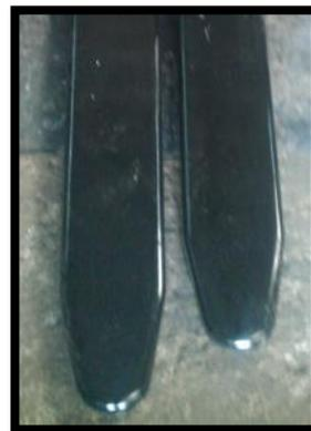
**Figura 76** Troquelado de la punta de las horquillas.
