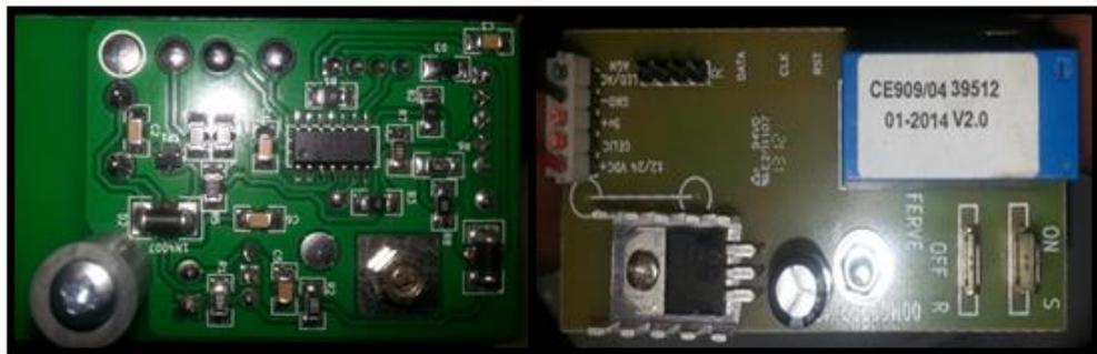
**Figura 82** Baquelita de doble lado impresa.
