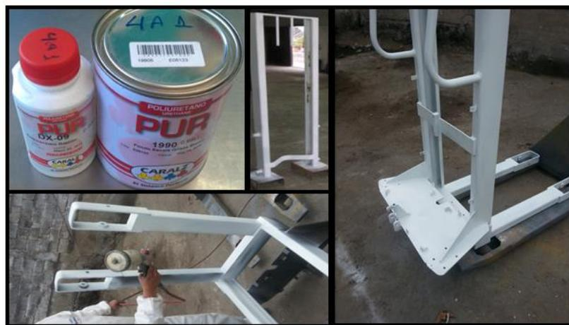
**Figura 73** Fondeado de la estructura principal.
