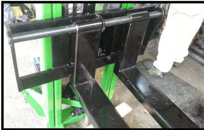
**Figura 78** Acabado final de porta-horquillas y horquillas.
