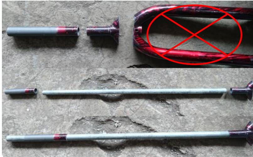
**Figura 75. Proceso de Construcción del Eje de Dirección**
