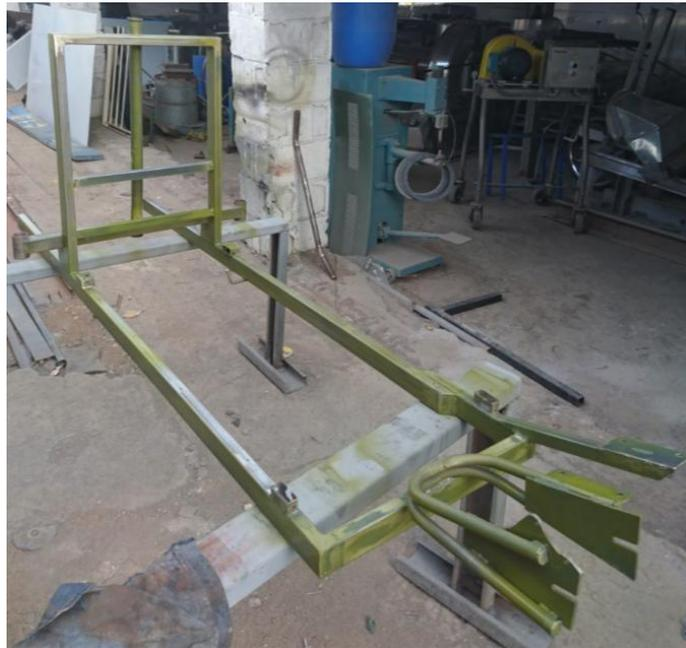
**Figura 83. Imprimación Estructura con WASH PRIMER**
