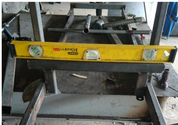
**Figura 72. Alineación y Nivelación de la estructura**
