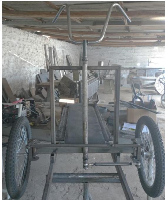
**Figura 78. Sistema de Dirección Ensamblado**
