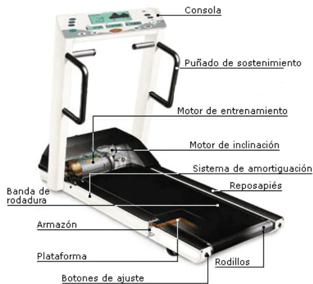
**Figura 7. Partes de una Caminadora Eléctrica**
