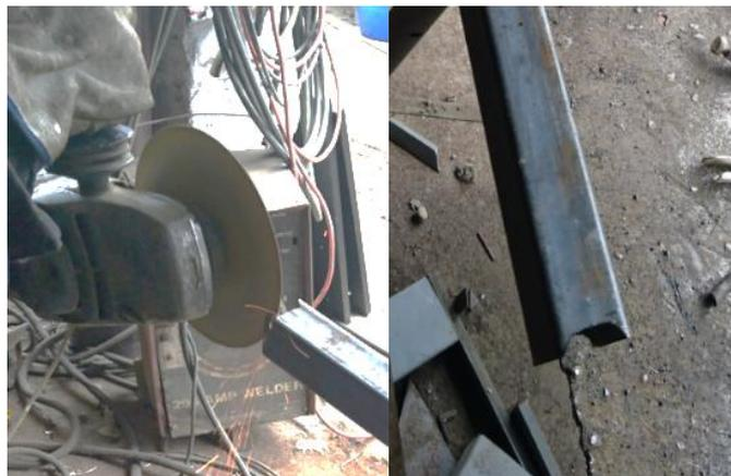
**Figura 70. Corte curvo en la parte delantera del chasis.**
