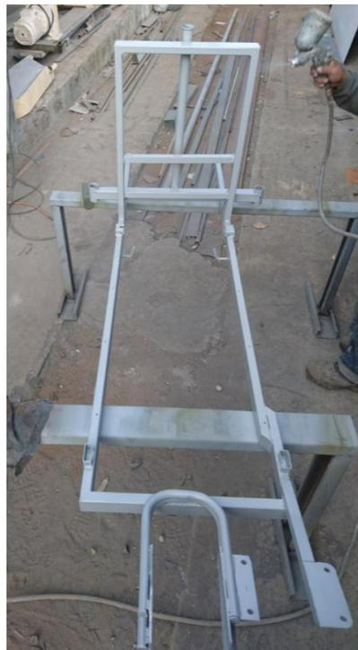
**Figura 84. Pintura Base Estructura**
