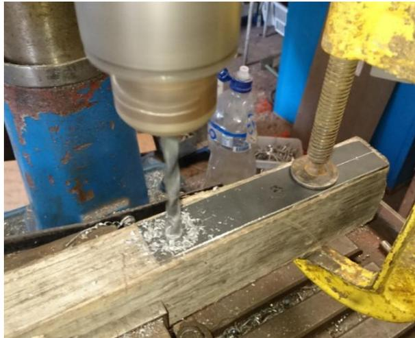
**Figura 76. Perforación de Brazo de la Rueda**
