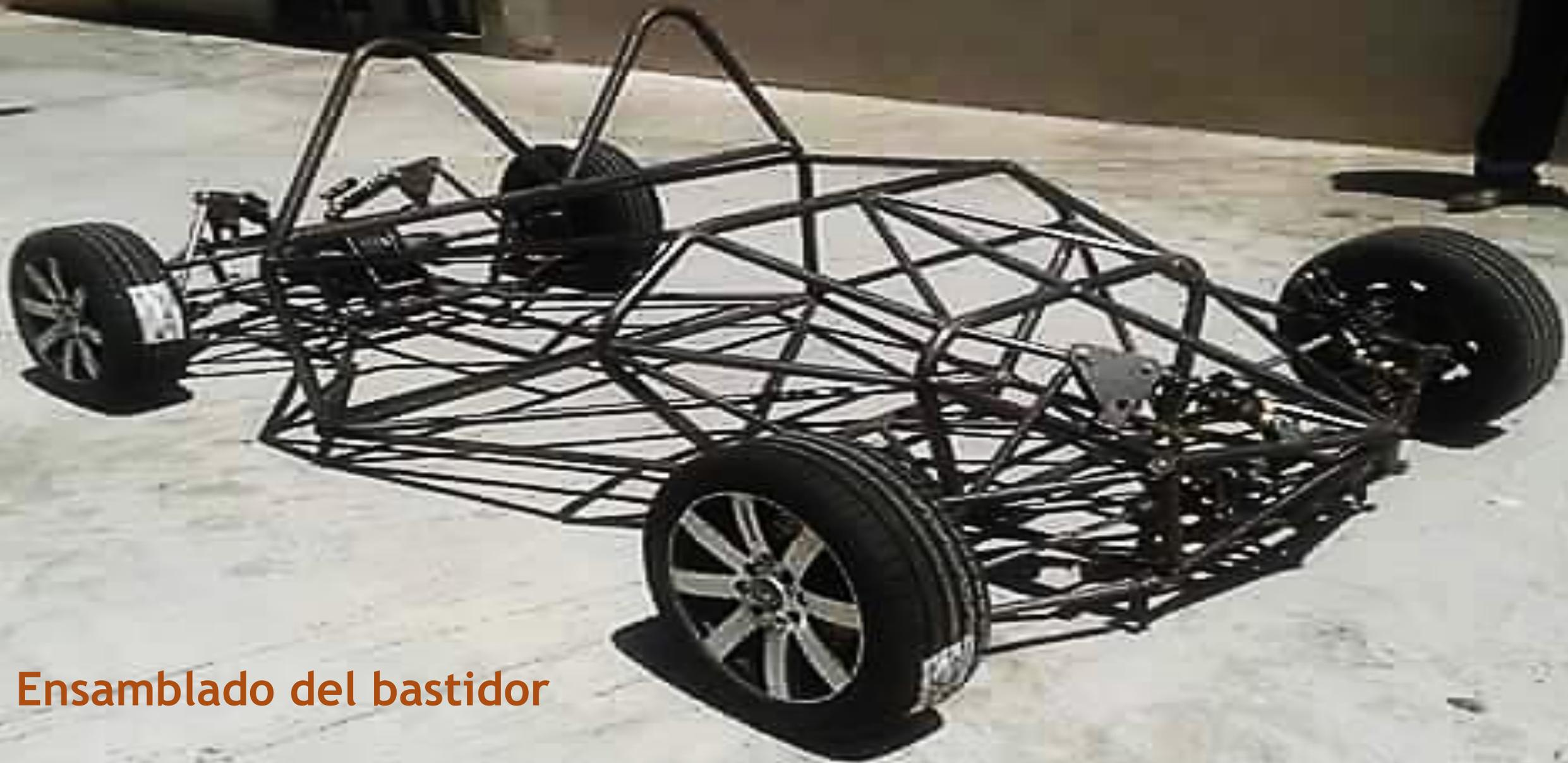
Ensamblado del bastidor
