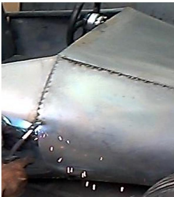
**Figura 68. Cubierta arco de seguridad y arco frontal**
