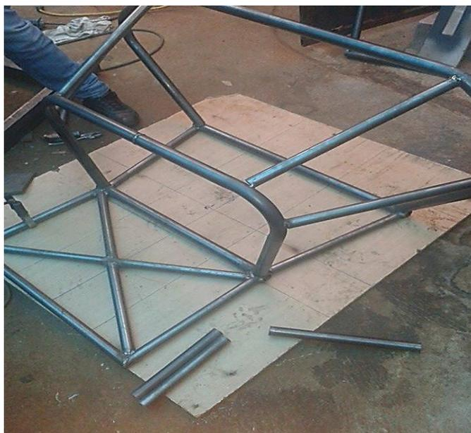
**Figura 60. Arco de seguridad y mampara delantera**
