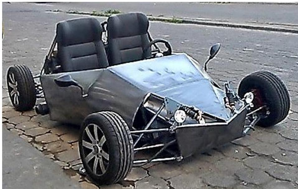
**Figura 73. Carrocería del vehículo**
