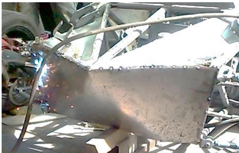
**Figura 66. Cubierta mampara delantera**
