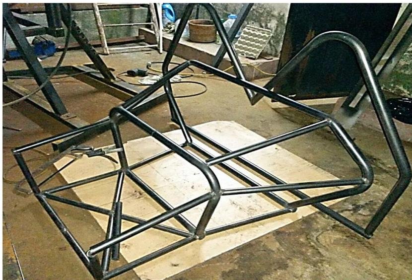
**Figura 59. Construcción arco principal y frontal**
