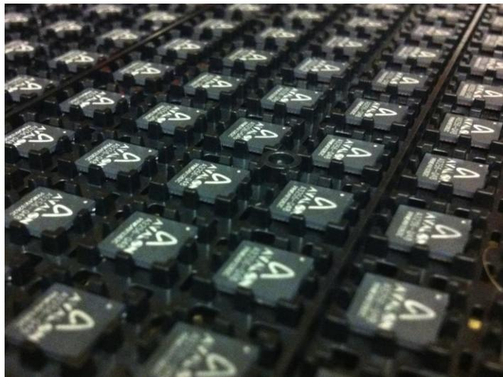
**Figura 17 Chips ASIC marca Avalon para Minería.**
