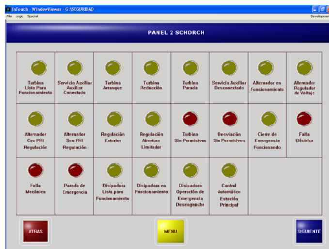
Figura 4.75 Pantalla SCADA de alarmas del panel SCHORCH # 2 Estación Recuperadora
