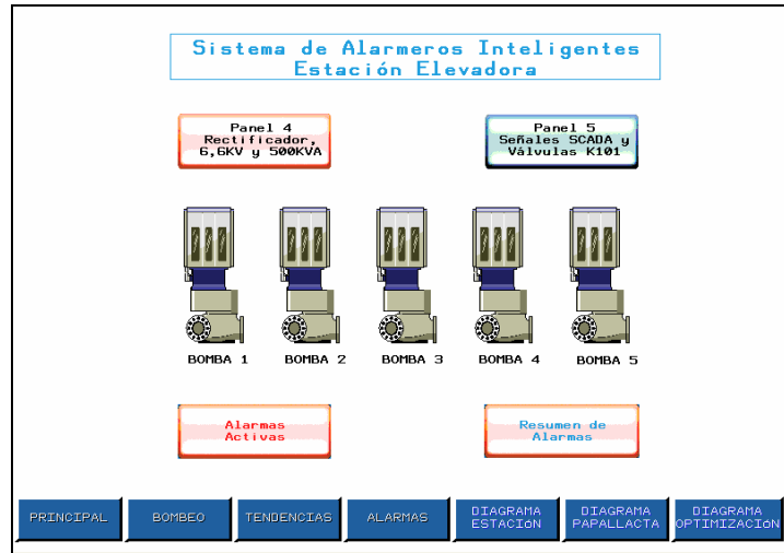
Figura 4.11 Pantalla de menú para el panel de operador Estación Elevadora.
