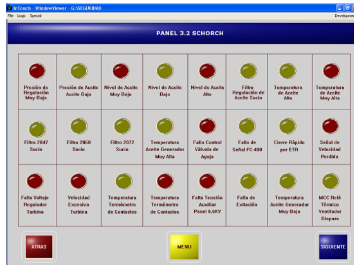
Figura 4.67 Pantalla SCADA de alarmas del panel SCHORCH # 3.2 de la Estación Recuperadora.
