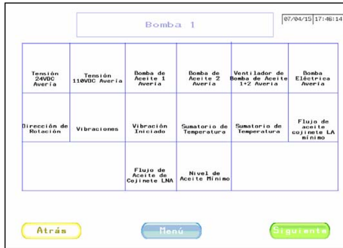
Figura 4.37 Pantalla de alarmas de la Bomba 1 Estación Booster I
