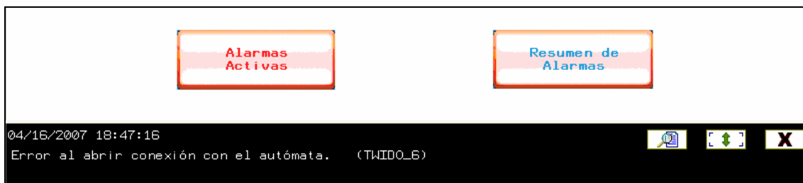
Figura 6.1 Tipo de falla generada en la pantalla de Operador al no encontrar al PLC dentro de la red.
