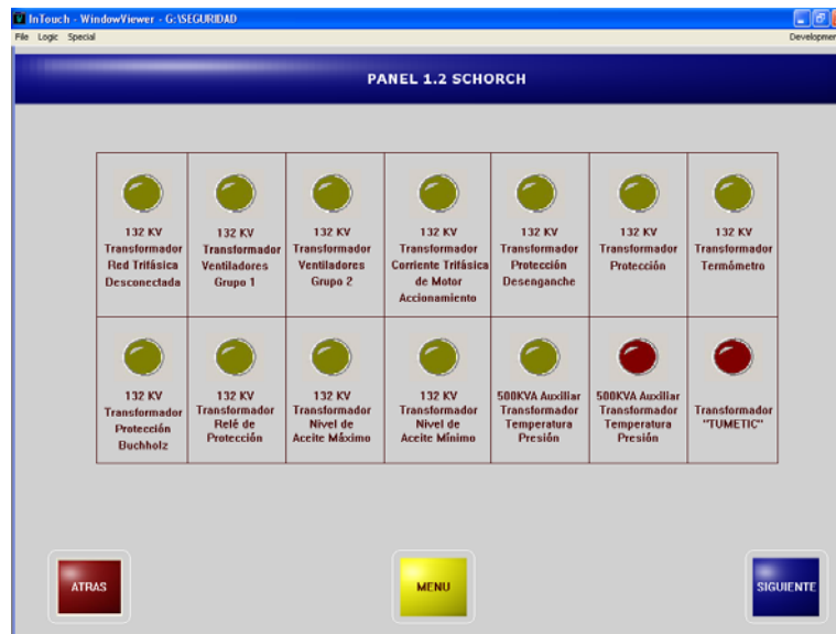
Figura 4.65 Pantalla SCADA de alarmas del panel SCHORCH # 1.2 de la Estación Recuperadora.
