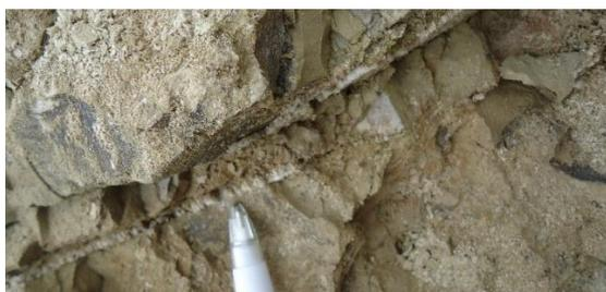
**Figura 43** Relleno de yeso de hasta 5 mm, entre los planos de estratificación.
