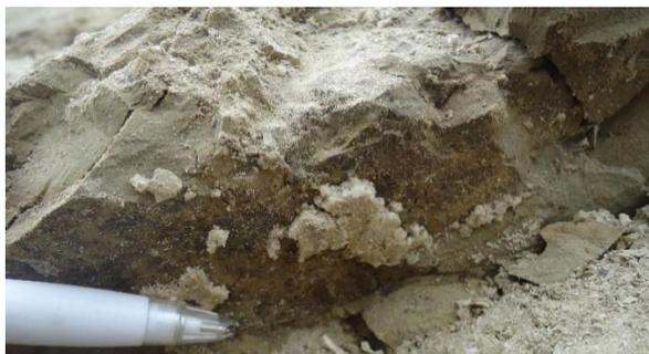
**Figura 42** Detalle de la rugosidad encontrada durante el levantamiento de las estaciones geomecánicas. La fotografía muestra una rugosidad plana lisa en planos de estratificación
