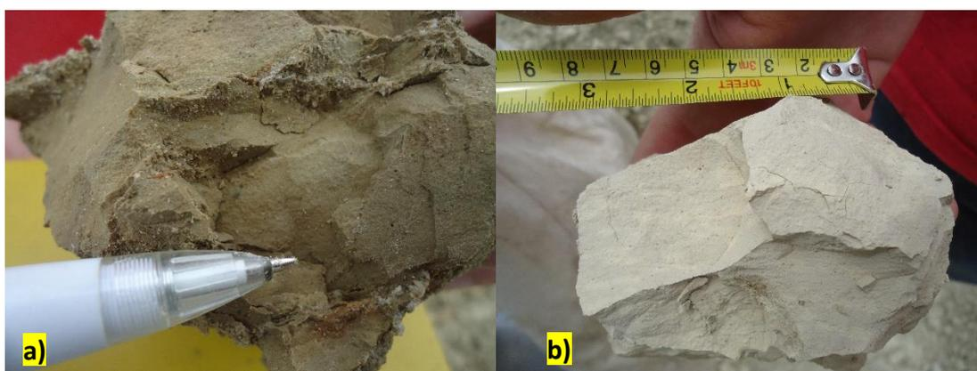
**Figura 26** a) Arcillolita de coloración café por contenido de humedad natural b) Arcillolita de coloración crema la muestra presenta diminutos agrietamientos por desecación.
