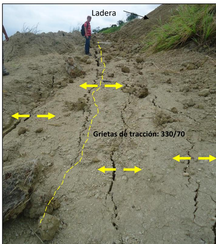
**Figura 78** Se observa el desarrollo de grietas de tracción (336/76 a 348/64) que se disponen en forma paralela a la ladera con aberturas de hasta 16 cm en la horizontal, en las coordenadas 648887E, 109333N; H: 31 msnm.
