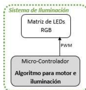
Figura 24. Sistema de iluminación
