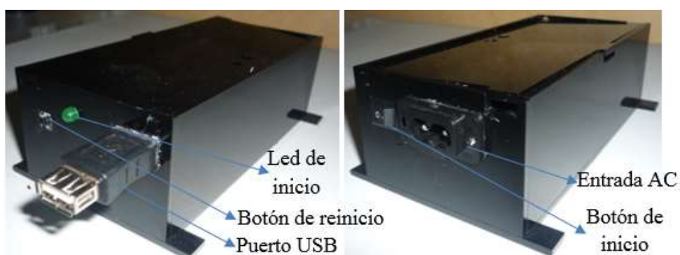
Figura 59. Caja de Control
