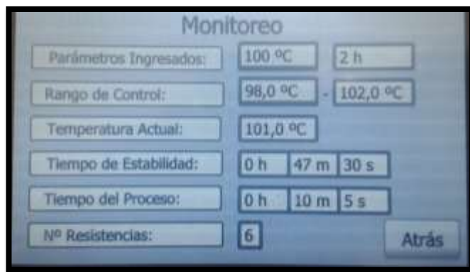
Figura 129. Monitoreo del control de temperatura a 100 °C
