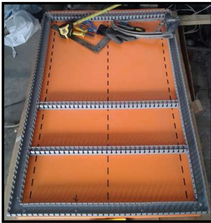
Figura 100. Montaje de canaletas
