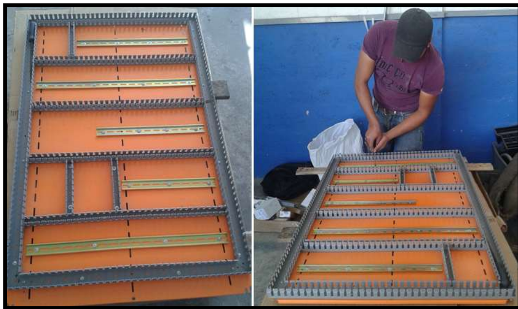
Figura 101. Montaje de canaletas
