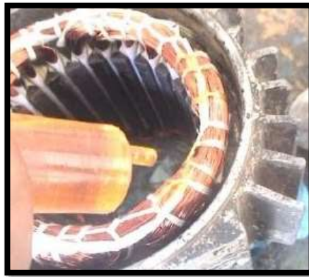
Figura 14. Barnizado del motor
