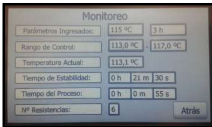
Figura 128. Monitoreo del control de temperatura a 115°C
