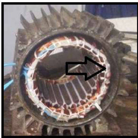
Figura 12. Sujeción del bobinado
