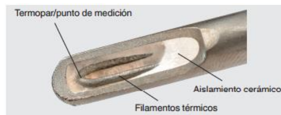
Figura 4 Partes de un termopar
