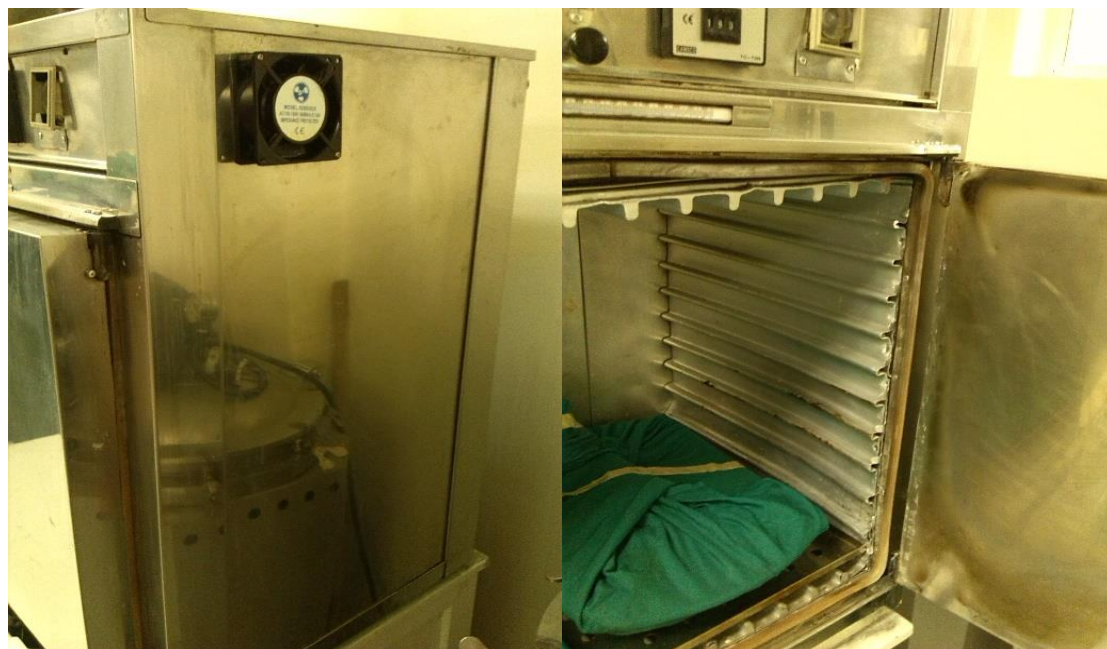
Figura 21 Fugas por selle de puerta deformado
