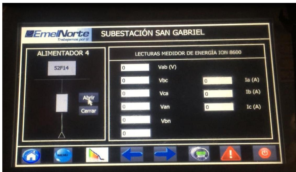
Figura 126 Mando de apertura del disyuntor de pruebas.
