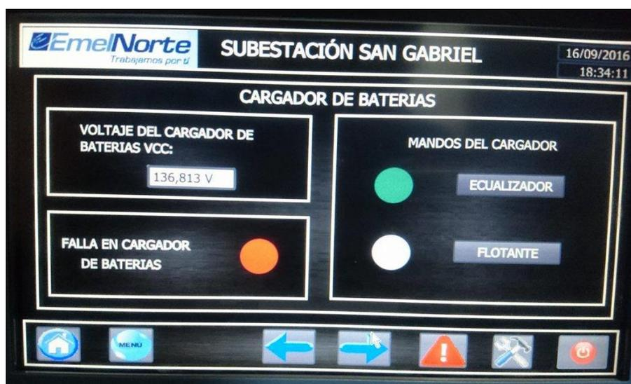
**Figura 108 Monitoreo y Control del Cargador de Baterías.**
