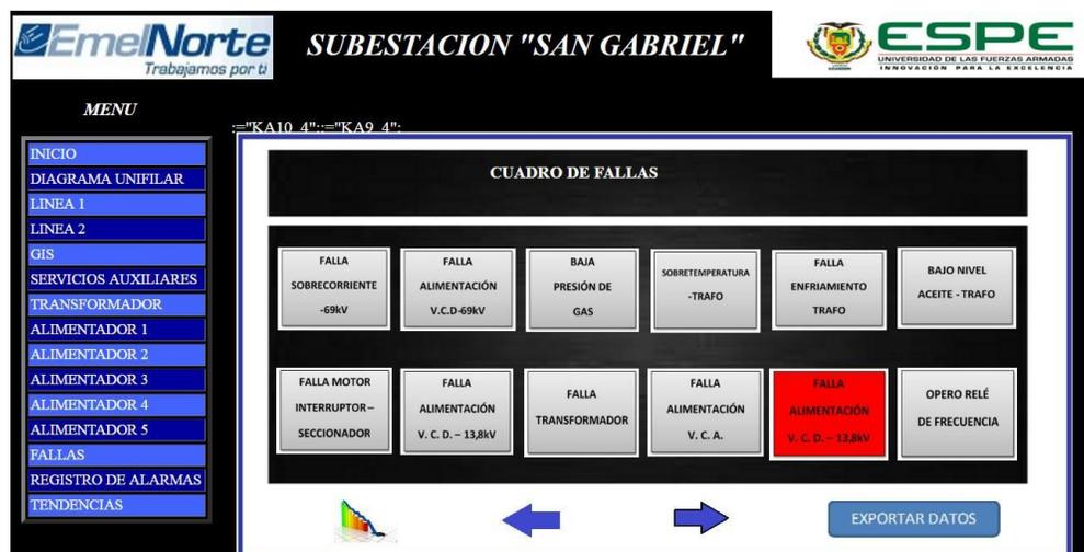
Figura 127 Activación de la Falla de Sobrecorriente en 13,8kV en la interfaz HMI.
