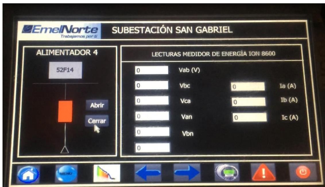
Figura 125 Mando de cierre del disyuntor de pruebas.
