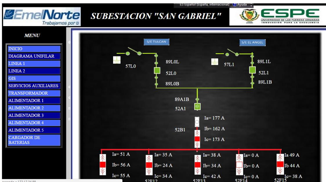
Figura 112 Diagrama unifilar del servidor web.
