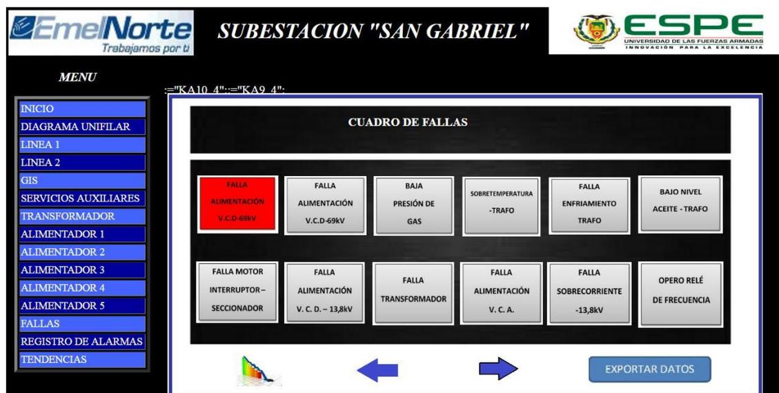
Figura 122 Activación de la falla en interfaz HMI.
