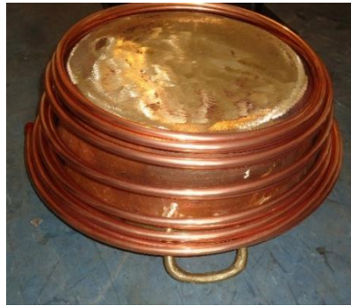
Figura No. 35. Fabricación del serpentín del evaporador.
