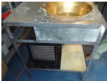
Figura No. 37. Estructura metálica y el sistema de refrigeración.
