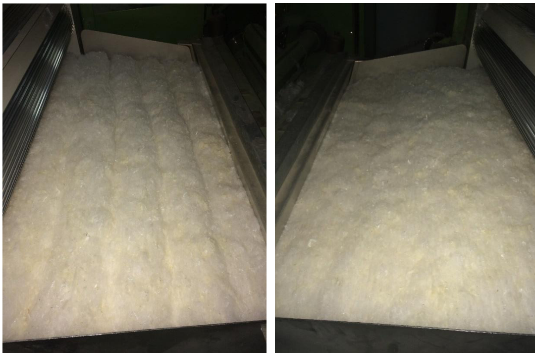
Figura 150 Comparación ingreso de material a la tolva de alimentación (Izquierda: Catarina anterior. Derecha: Catarina actual)
