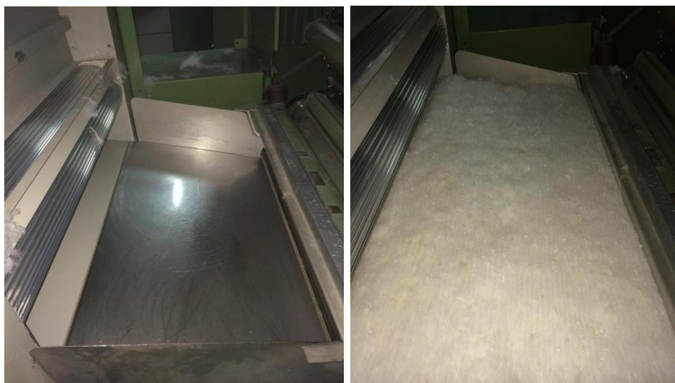
Figura 26 Tolva de alimentación vacía (izq) y llena con el material compacto y uniforme (der).
