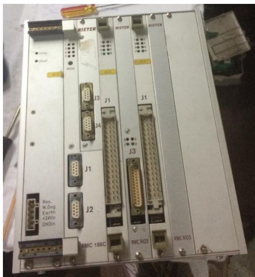
Figura 127 Controlador antiguo desmontado del tablero principal de control
