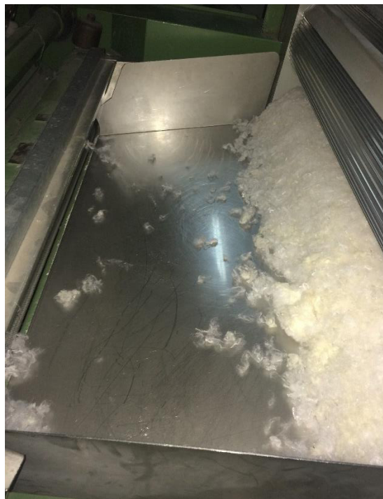
Figura 161 Inicio de ingreso del material en la tolva de alimentación
