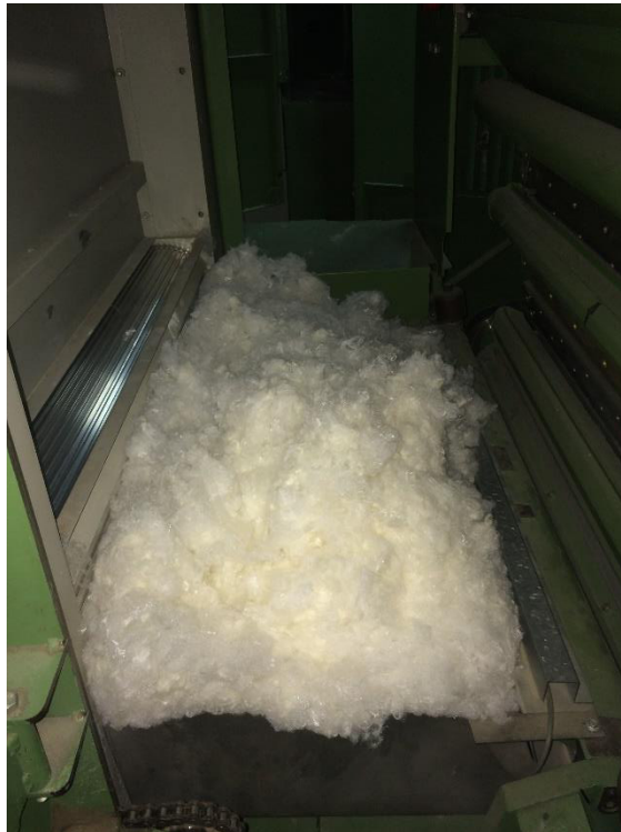
Figura 160 Excesivo ingreso de material al cilindro alimentador
