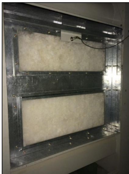
Figura 25 Silo lleno de material en la entrada de la máquina carda C50
