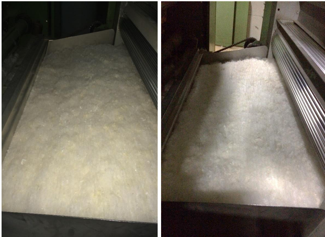
Figura 158 Comparación ingreso de material a la tolva de alimentación (Izquierda: Solo corrección mecánica. Derecha: Corrección mecánica y eléctrica)
