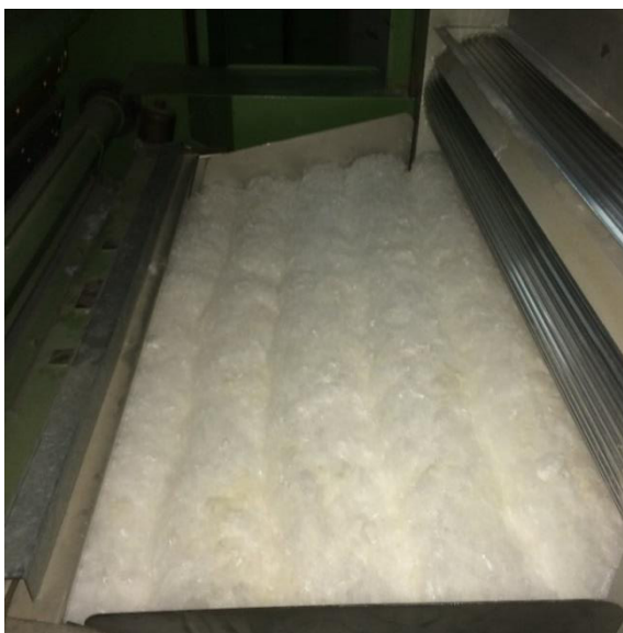
Figura 138 Ingreso irregular de material en la tolva proveniente del Silo
