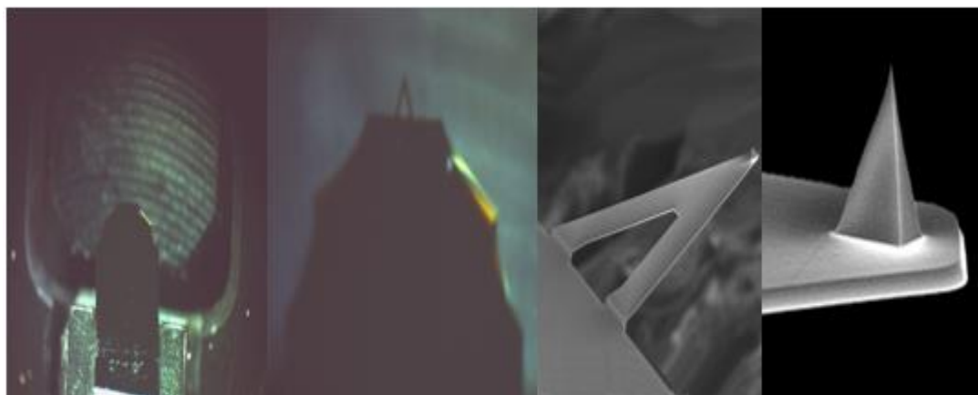
Figura 27. Vista ampliada de la punta de prueba SCANASYST-AIR
