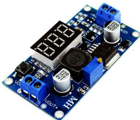
**FIGURA 74. MÓDULO ELEVADOR DE VOLTAJE**
