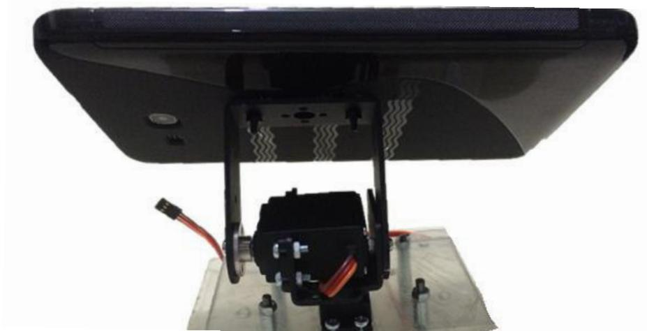
**FIGURA 82. SUJECIÓN PANTALLA**
