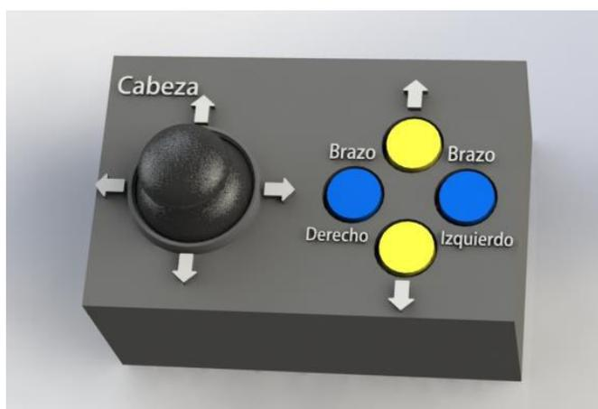
**FIGURA 60. DISEÑO DEL JOYSTICK**
