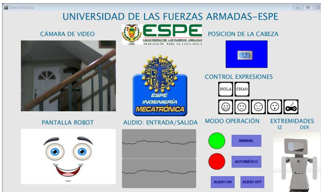
**FIGURA 63. ESQUEMA DE DISEÑO DEL HMI DE ESPECIALISTA**
