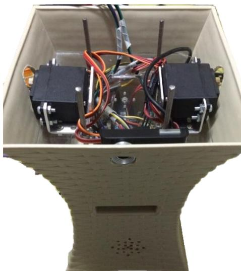
**FIGURA 78. ENSAMBLE DE PLACABASE**
