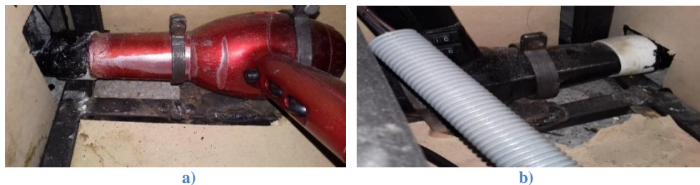
a) b) Figura 73 Construcción e instalación del subsistema de calefacción (a) Secadora y soporte ubicada en el lado derecho de la cabina, (b) Secadora y soporte ubicada en el lado izquierdo de la cabina
