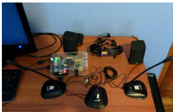
Figura 8 Sistema Embebido de un audífono inteligente Fuente: (Castillo & Díaz, 2015)
