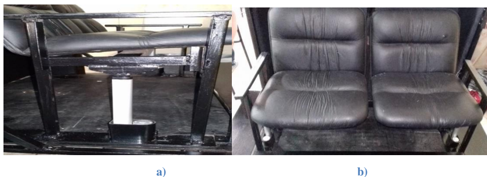
Figura 78 Sistema de movimiento (a) Pistón ubicado bajo los asientos con el soporte, (b) Conjunto general de los asientos
