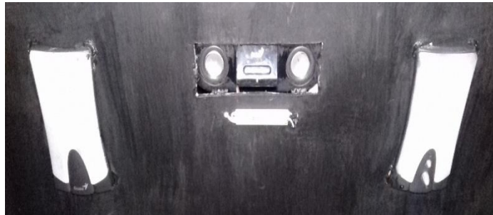
Figura 75 Instalación del subsistema de audio
