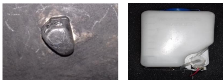
a) b) Figura 74 Conjunto del sistema de agua (a) Rociador de agua, (b) Depósito de agua con motor-bomba
