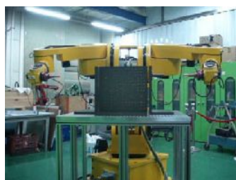
Figura 8: Robot dual colaborativo de dos brazos Fuente: [Park et al., 2010]
