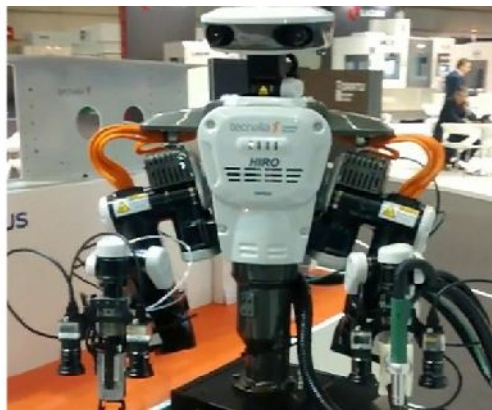
Figura 21: Robot Kawada Nextage Open de Tecnalía. Robot bi-brazo Fuente: [Herrero et al., 2016]
