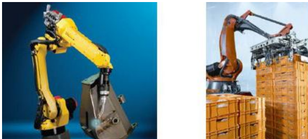
Figura 10: Aplicaciones para a) Robot FANUC soldador, b) Robot KUKA en un sistema de paletización
