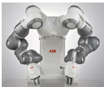
Figura 7: YuMi - robot colaborativo de dos brazos Fuente: [ABB, 2015]
