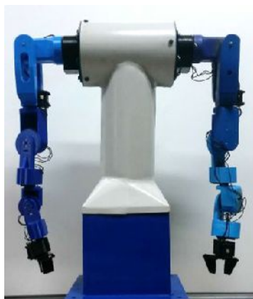
Figura 79: Implementación del torso robótico colaborativo de dos brazos antropomorfos completo
