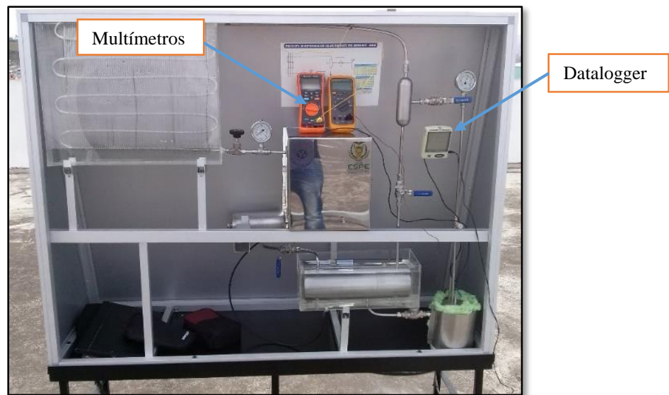
Figura 58: Equipos instalados en el prototipo de refrigeración
