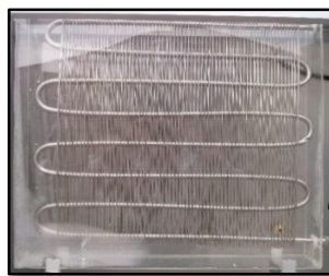
Figura 55: Condensador inundado en agua
