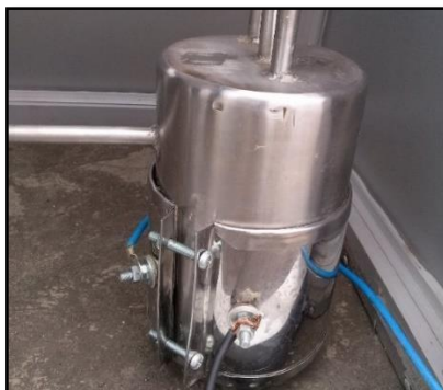
Figura 33: Resistencia eléctrica tipo abrazadera colocada en el generador
