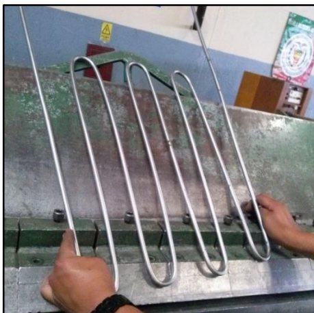
Figura 39: Diseño del condensador de tubos y aletas
