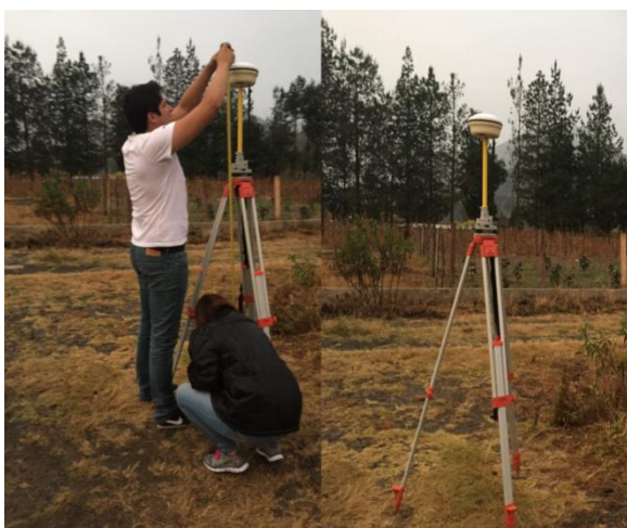
Figura 36.- Toma punto, utilizando procesamiento estático.
