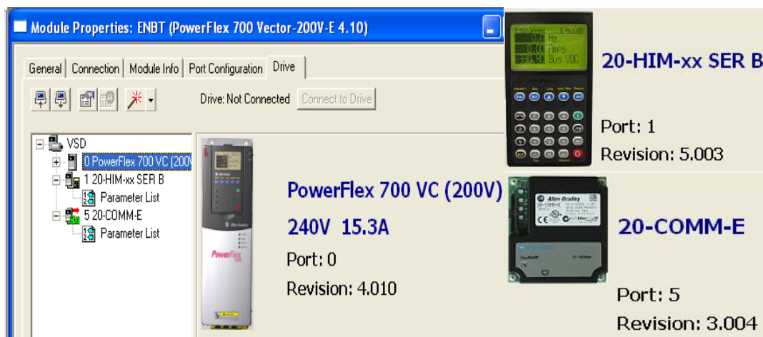
Figura 165 VSD correctamente agregado al proyecto
