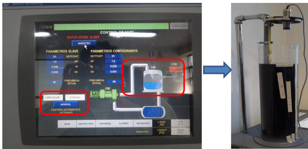
Figura 172 Verificación manual para el llenado del Tanque
