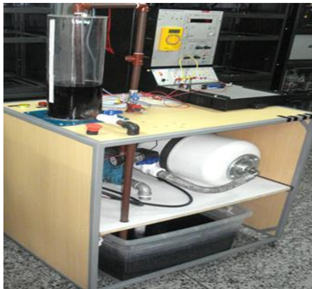
Figura 17 Modulo de control de Nivel
