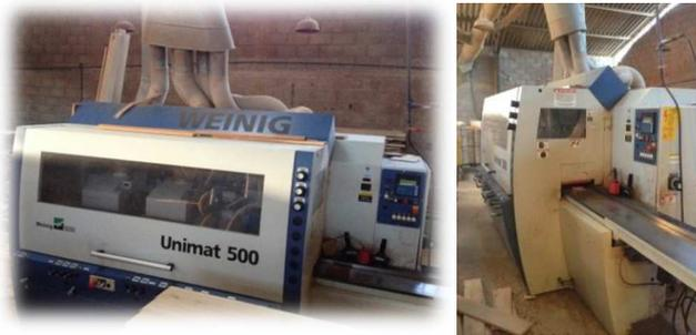
**Figura 32. Máquina machihembradora**
