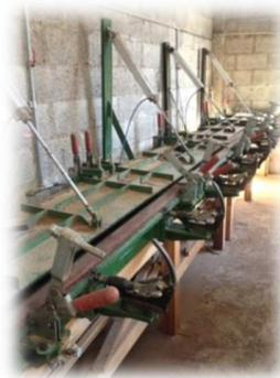
**Figura 31. Máquina para prensar las latillas**
