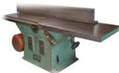
**Figura 29. Máquina canteadora**
