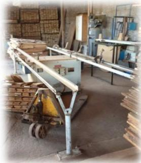
**Figura 28. Máquina latilladora**
