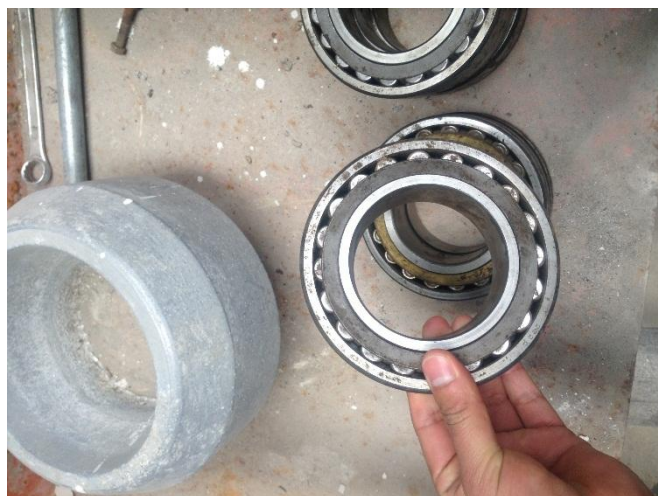
Figura 97 Selección de rodamientos, SKF de 3 in de diámetro interno
