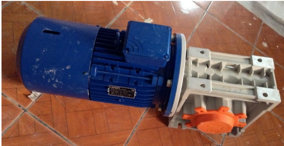
Figura 103 Selección del motorreductor
