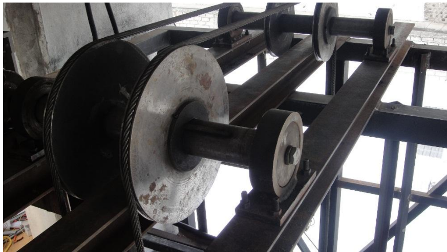
Figura 99 Selección e implementación de eje, poleas y chumaceras
