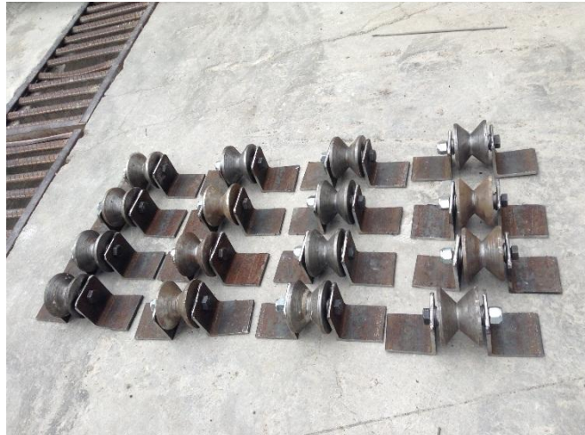
Figura 96 Ruedas guía para rigidizar el deslizamiento de la cabina
