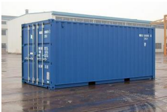
Figura 21. Contenedor de 20 pies (6 m.) para carga sólida Fuente:(ZARCA S.L.)
