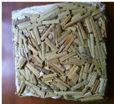
Figura 8. Paneles con tamaño de partícula de 3cm
