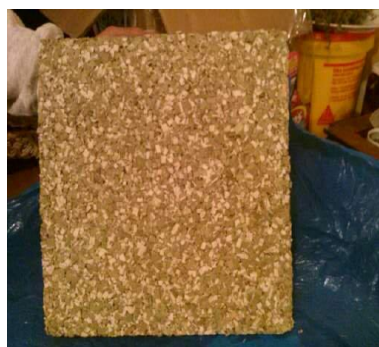
Figura 10. Paneles con tamaño de partícula de 0,5 cm
