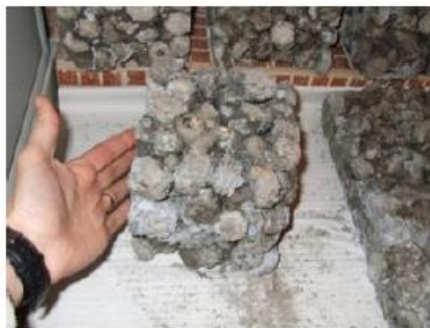
Figura 4. Hormigón ligero de mazorca de maíz
