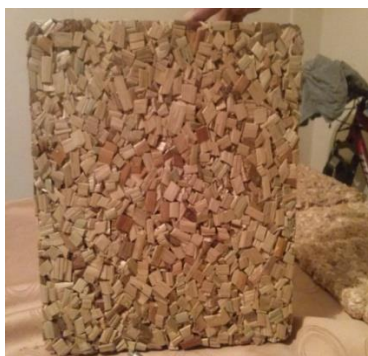
Figura 9. Paneles con tamaño de partícula de 1cm
