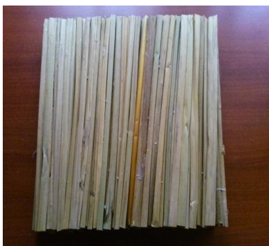
Figura 7. Paneles con tamaño de partícula de 30cm
