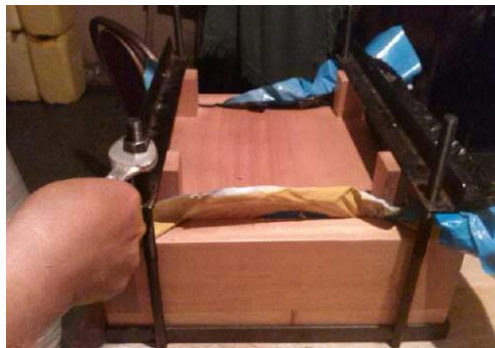
Figura 11. Prensa para placas rígidas de Totora
