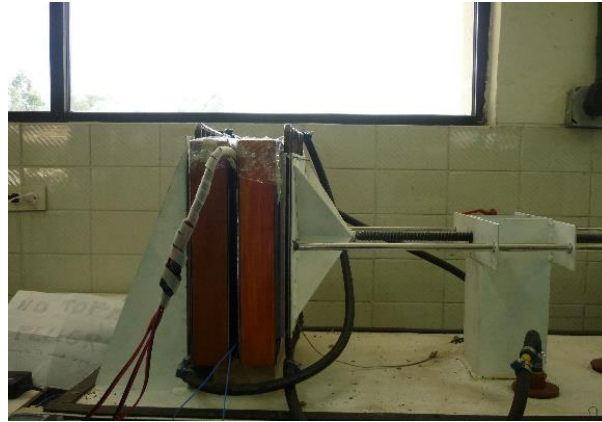
Figura 30. Medición del coeficiente de conductividad térmica de Totorá a granel
