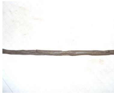
Figura 18. Fisuras y grietas de la muestra
