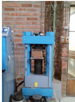
Figura 35. Ensayo de la resistencia a la compresión
