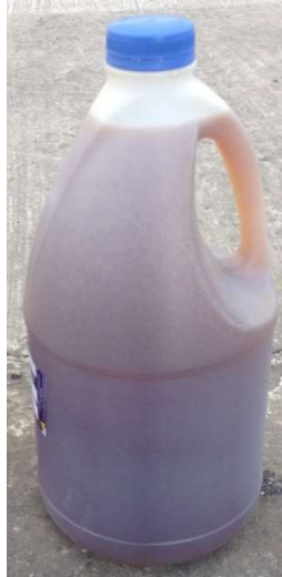
Figura 95 Glicerina extraída de la transesterificación
