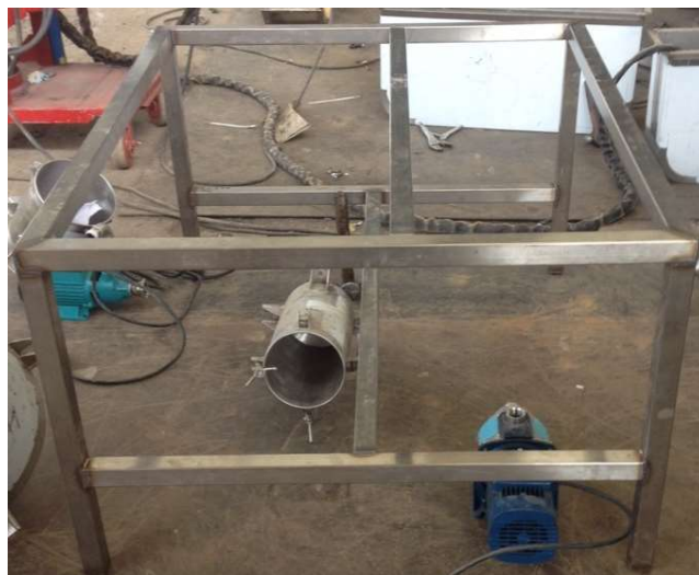
Figura 83 Estructura de la base metálica del Bastidor.
