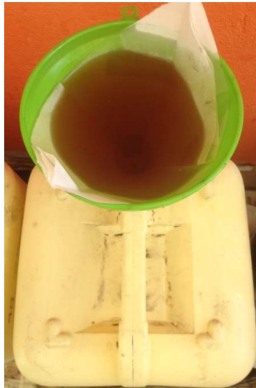
Figura 92 Filtrado del aceite reciclado
