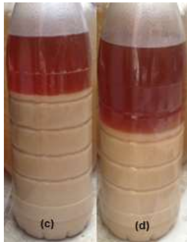
Figura 100 Segunda etapa de la disolución de la emulsión
