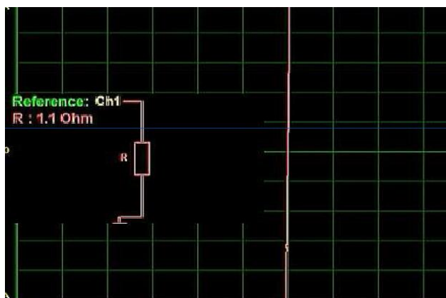
Figura 58 Test en terminal de alimentación para la bobina COP. Fuente: (Augeri, 2015)
