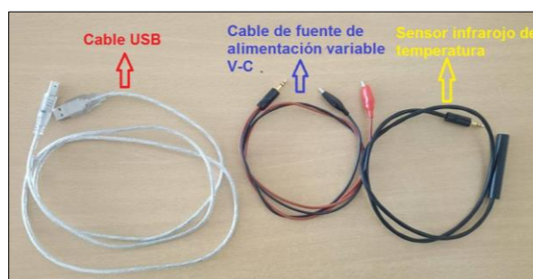
Figura 113 Cables adicionales, USB, sensor de temperatura y fuente variable de alimentación DC.
