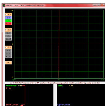
Figura 177 Curva v-i en el cable de referencia baja del socket que conecta al sensor ECT
