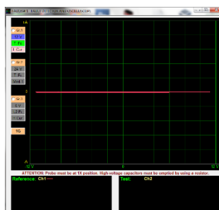
Figura 201 Curva v-i en el cable de alimentación del socket para la bobina DIS
