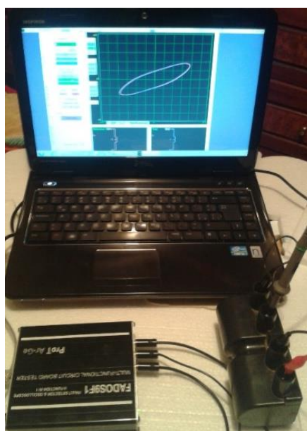
Figura 63 Obtención de curva voltaje - corriente en el secundario de la bobina DIS chispa perdida.
