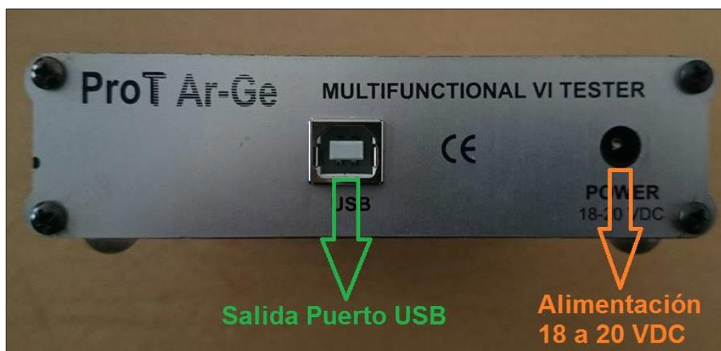
Figura 111 Entradas de la parte posterior del analizador y osciloscopio multifuncion de pruebas voltaje - corriente.
