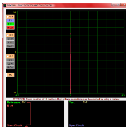
Figura 270 Curva v-i entre las terminales del interruptor del pedal del acelerador
