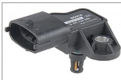
Figura 75 Sensor de presión en el múltiple de admisión. Fuente: (Puluc, 2014)
