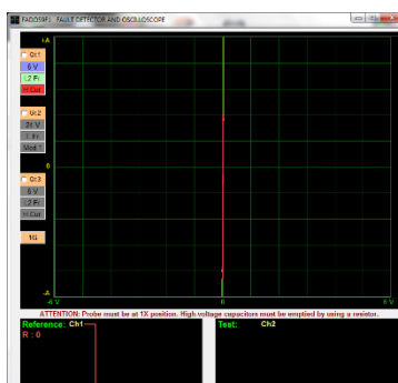
Figura 181 Curva v-i en el cable de referencia baja en el socket del sensor KS
