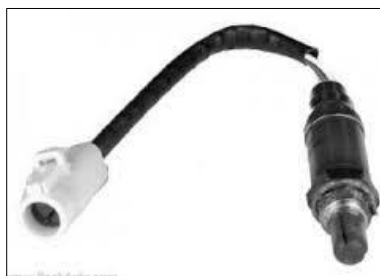
Figura 78 Sensor lambda o de oxígeno. Fuente: (Ocaño, 2013)
