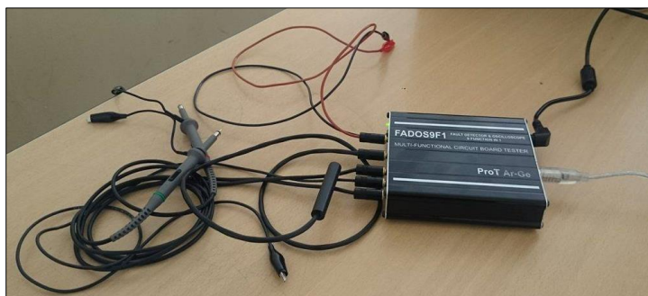
Figura 114 Analizador y osciloscopio multifuncion de pruebas voltaje - corriente.
