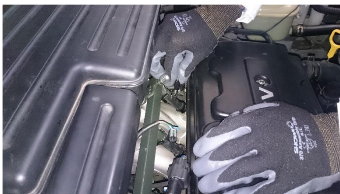
Figura 131 Ubicación de la masa del equipo a una de las terminales del inyector
