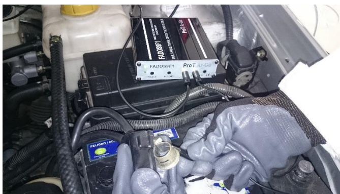
Figura 126 Conexión de la masa del equipo al cable negativo que conecta a la batería
