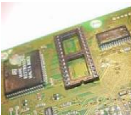
Figura 27 Extracción de la memoria por sócalo
