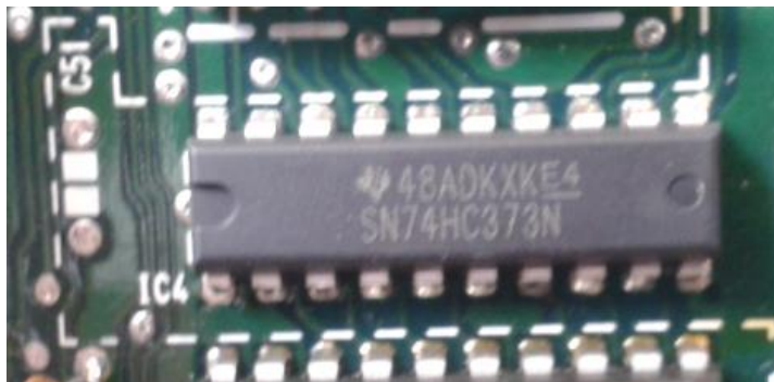
Figura 70 Integrado 74HC373 instalado
