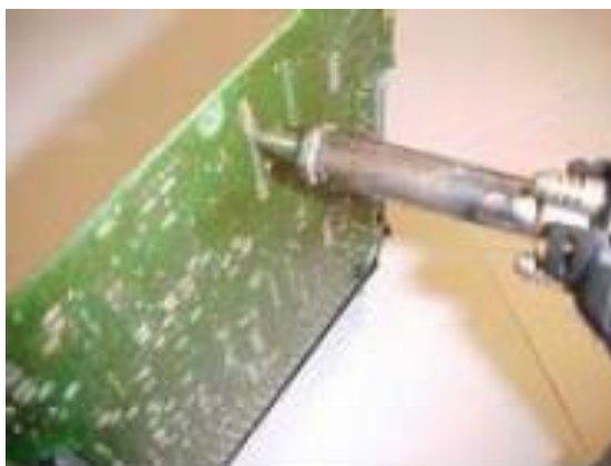
Figura 26 Extracción de la memoria desoldándola
