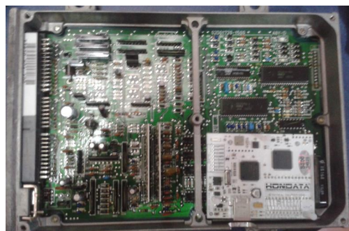
Figura 1 Modulo lector instalado
