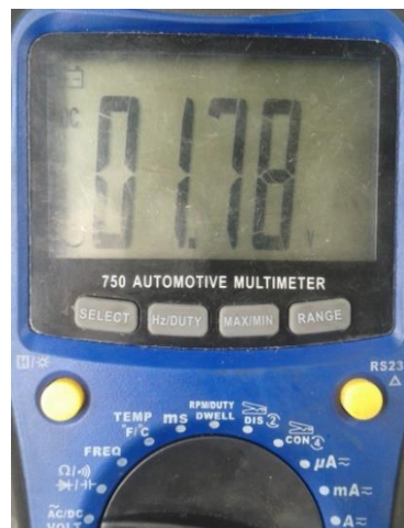
Figura 148 Voltaje a 3/4 de cantidad del depósito
