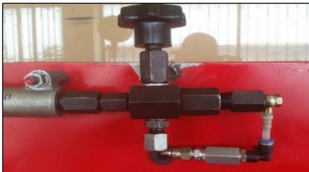
**Figura 58: Válvula de alta presión de aguja y ajuste manual**
