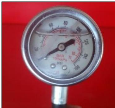
**Figura 55: Manómetro de baja presión 0-160 psi 11 bar**
