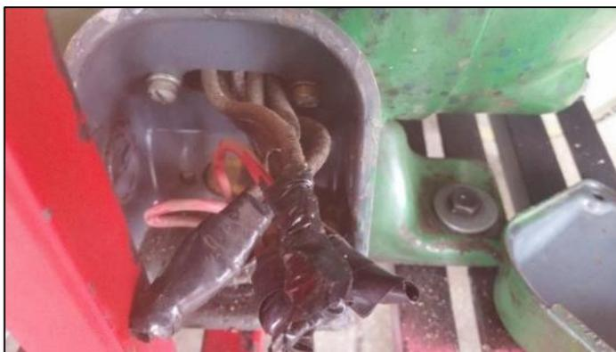
**Figura 70: Conexión de las líneas para alimentación 220v**
