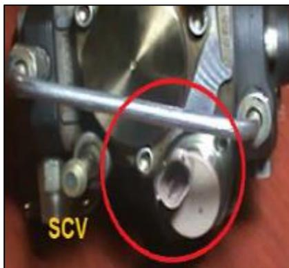
**Figura 27: Válvula de control de succión**
