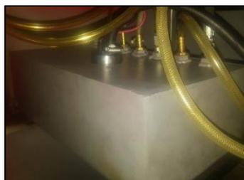
**Figura 54: Depósito de combustible**
