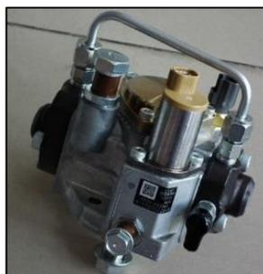
**Figura 50: Bomba de alta presión****3.3.1. Cálculos de caudal de la bomba de alta presión**
