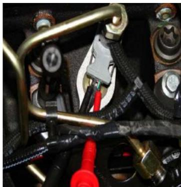
**Figura 34: Medición de la señal a los inyectores**
