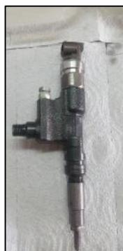
**Figura 99: Inyector inductivo Denso.**
