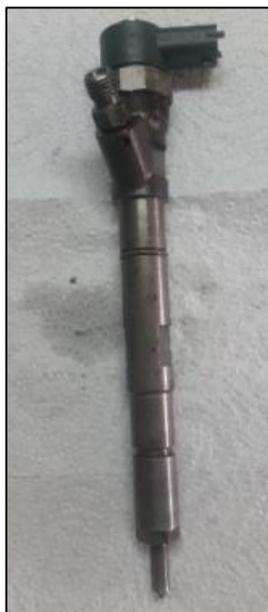
**Figura 81: Inyector Inductivo Bosch**
