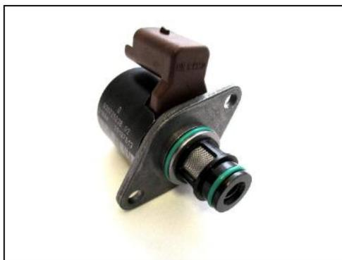
**Figura 28: Válvula de alta presión**
