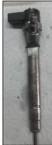
**Figura 90: Inyector inductivo Bosch**
