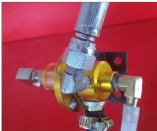
**Figura 57: Válvula de baja presión 0.8 – 8 bar.**
