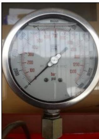
**Figura 56: Manómetro de alta presión 0-20000 psi 1400 bar**
