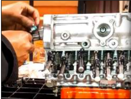
Figura 117. Montaje de la porta cojinete.
