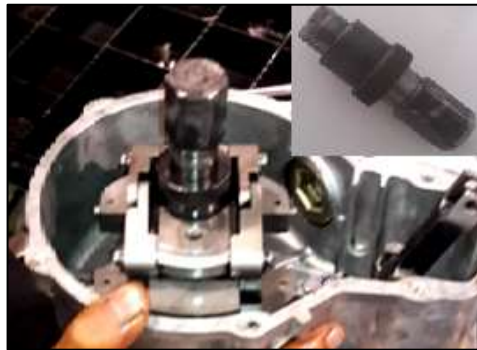
Figura 94. Desajuste de tuerca de contrapesas
