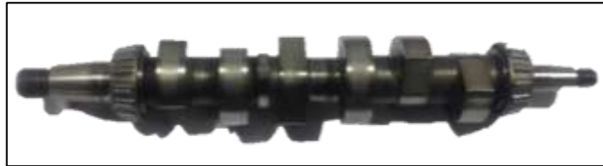
Figura 17. Árbol de levas bomba tipo P
