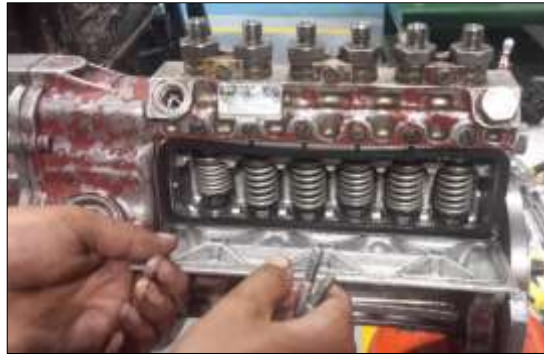
Figura 89. Desmontaje de la tapa de la bomba de inyección.
