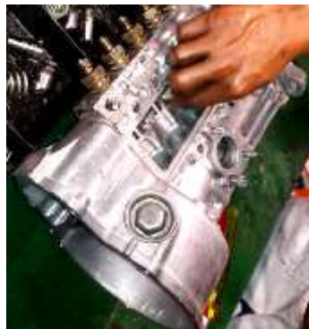
Figura 105. Extracción la camisa de regulación con el platillo superior y el sector dentado.
