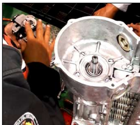
Figura 95. Extracción del conjunto de contrapesas
