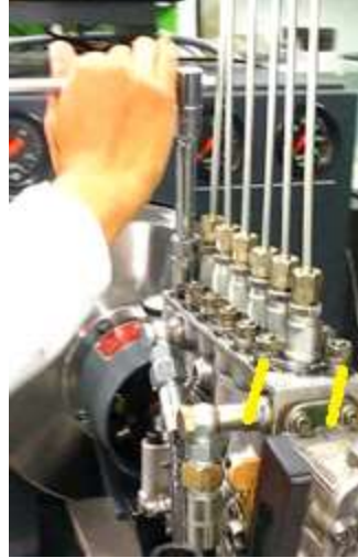
Figura 161. Calibración de caudal
