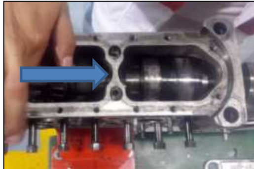
Figura 79. Extracción del árbol de levas.
