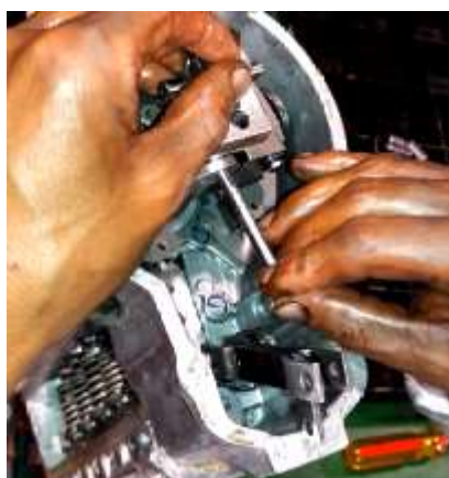
Figura 121. Montaje del pasador.
