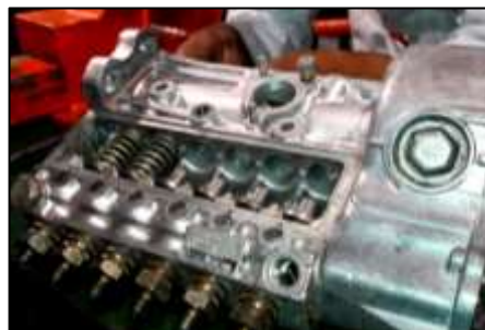
Figura 103. Extracción de conjuntos de impulsión.
