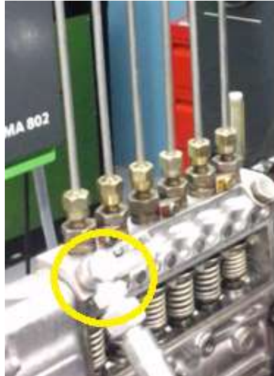
Figura 180. Entrada de combustible
