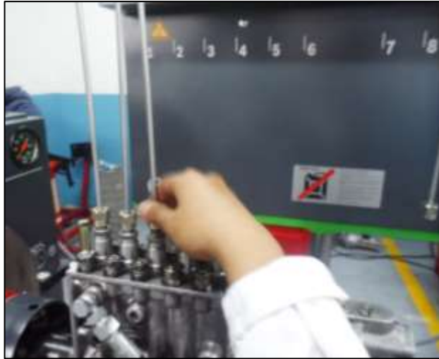
Figura 151. Montaje de cañerías
