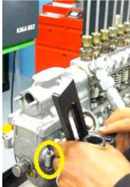
Figura 193. Tornillo de regulación.
