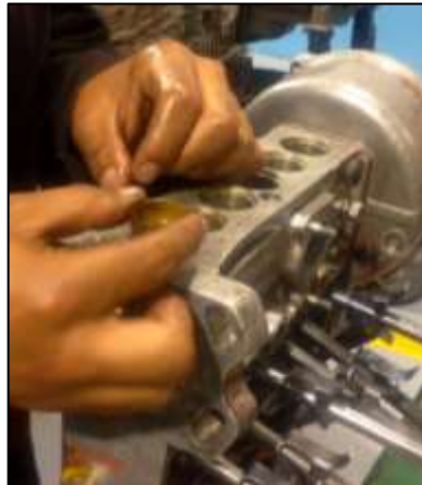
Figura 100. Extracción de tapones inferiores.
