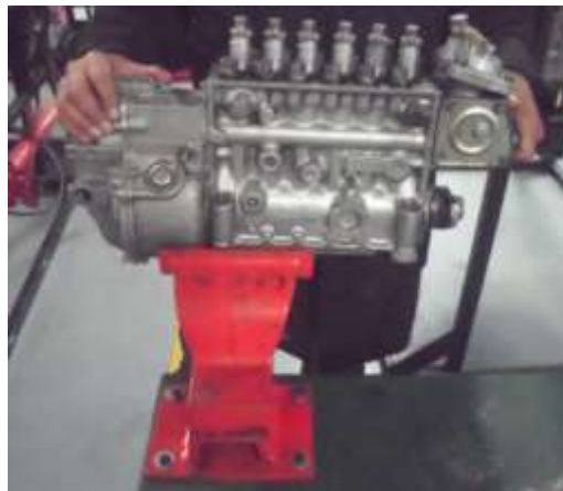
Figura 64. Bomba de inyección lineal montado en el dispositivo
