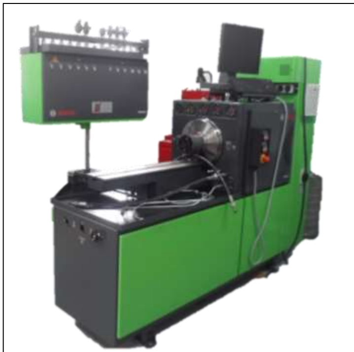
Figura 26. Banco de pruebas Bosch EPS 815
