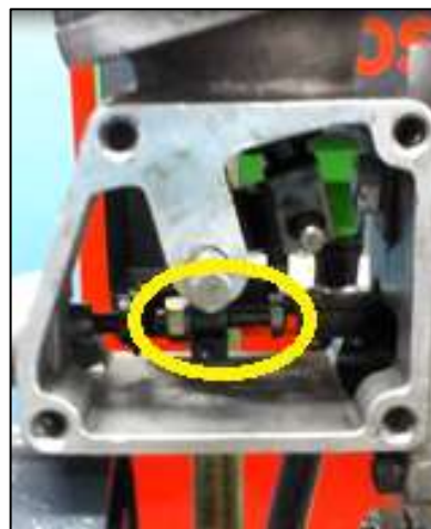
Figura 173. Tornillo de regulación
