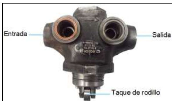
Figura 13. Bomba de alimentación
