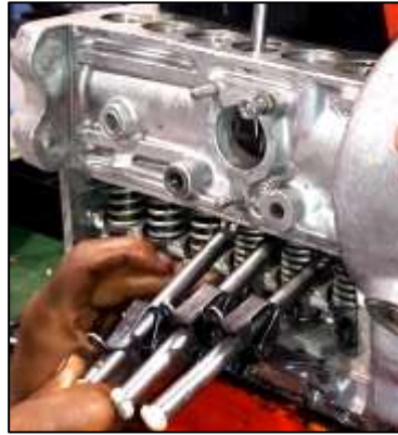
Figura 115. instalación de los sujeta-empujadores
