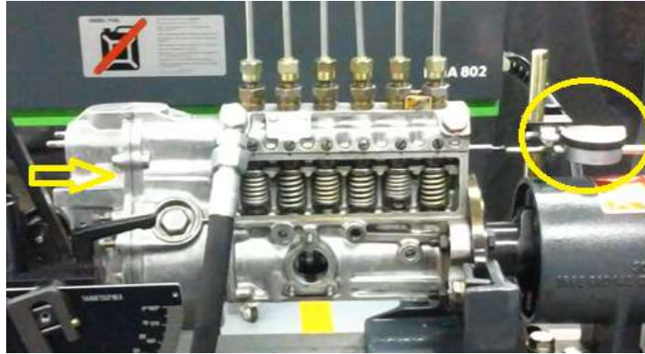
Figura 194. Verificación del recorrido de la cremallera
