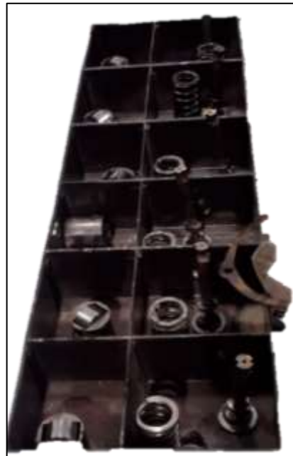
Figura 82. Elementos de bombeo.
