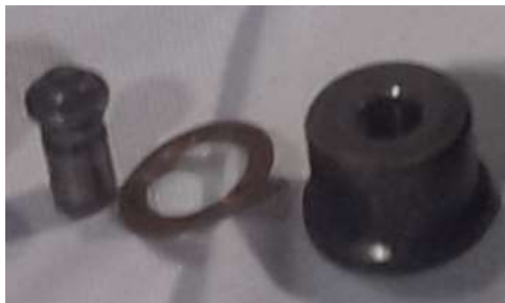
Figura 85. Válvulas de presión.
