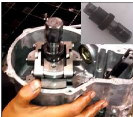
Figura 119. Ajuste del conjunto de contrapesas.
