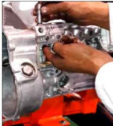
Figura 110. Montaje del conjunto de impulsión de combustible
