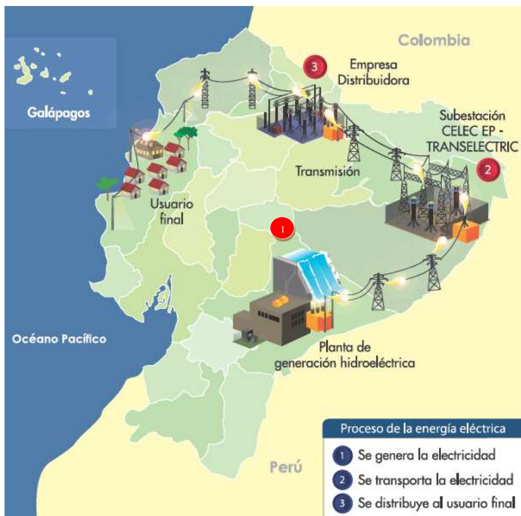
Figura 9 Proceso de la energía eléctrica
