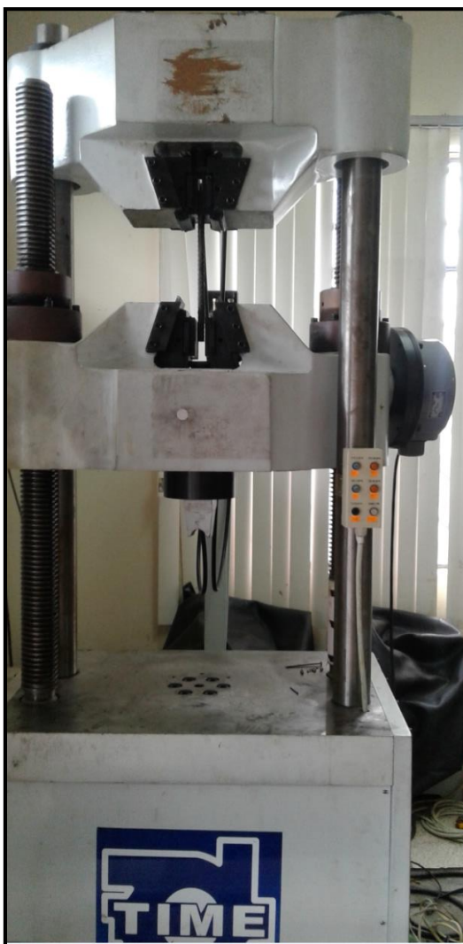
Figura 101 Colocación de la probeta en las mordazas
